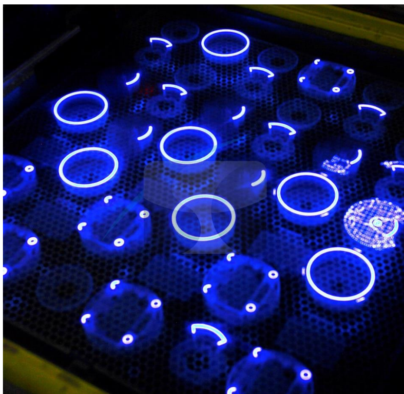
Slika 16. Primjer izrade više izradaka odjednom, pomoću SLA postupka. [13]
