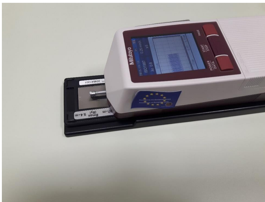
Slika 30. Prikaz kalibracije mjernog uređaja pomoću odgovarajućeg etalona.
