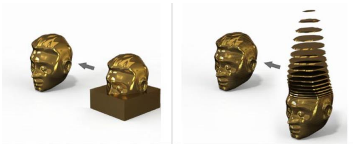
Slika 2. Usporedba izrade modela pomoću oblikovanja odvajanjem čestica i aditivnih postupaka. [2]
