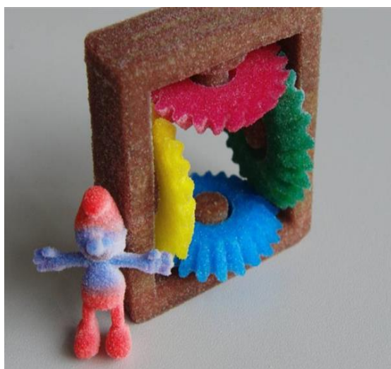
Slika 12. Primjer izradaka pomoću 3D tiska. [12]
