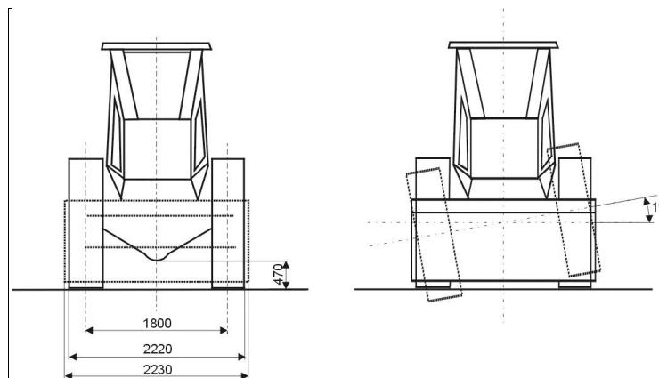
Slika 8. Razmak kotača i oscilacija osovine [4]
