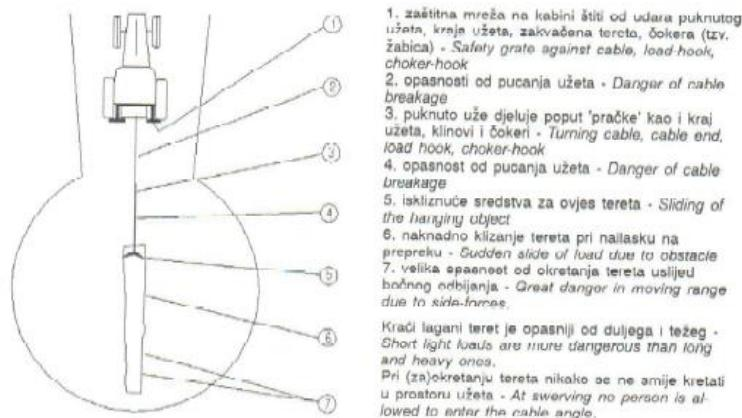
Slika 17. Opasnosti i zaštitne mjere pri radu s vtlom [11]
