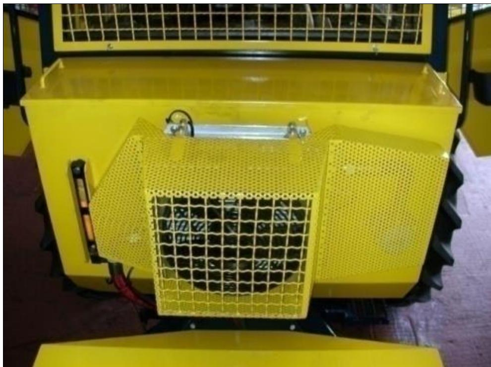
Slika 18. Štitnik ventilatora i kućište [1]
