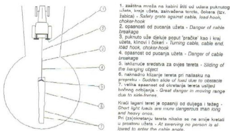
Slika 17. Opasnosti i zaštitne mjere pri radu s vitlom [11]
