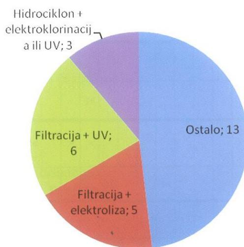
Slika 26. Konfiguracija procesa tretmana: kombinacija filtracija ili hidrociklona s elektro-klorinacijskom elektrolizom ili UV zračenjem.
