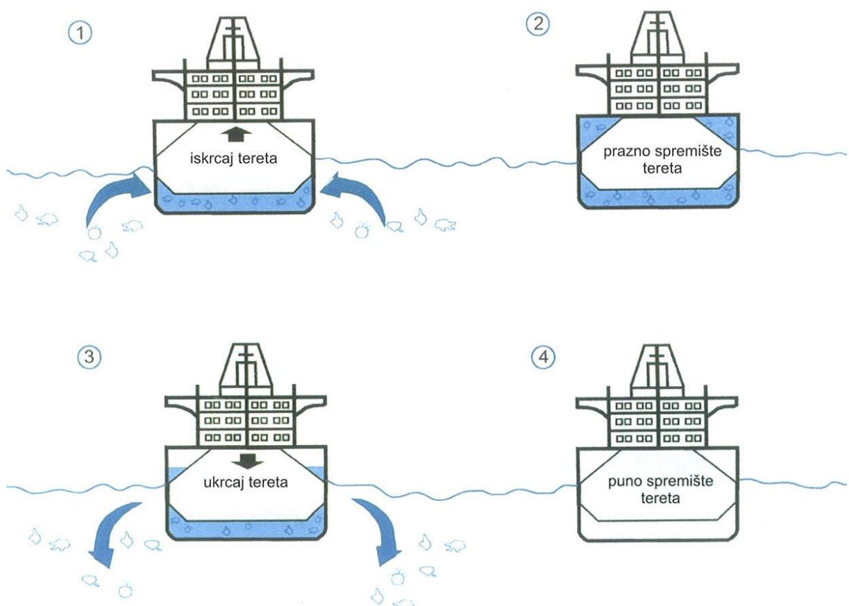
Slika 1. Presjek broda i ilustracija uloge balastnih voda.
