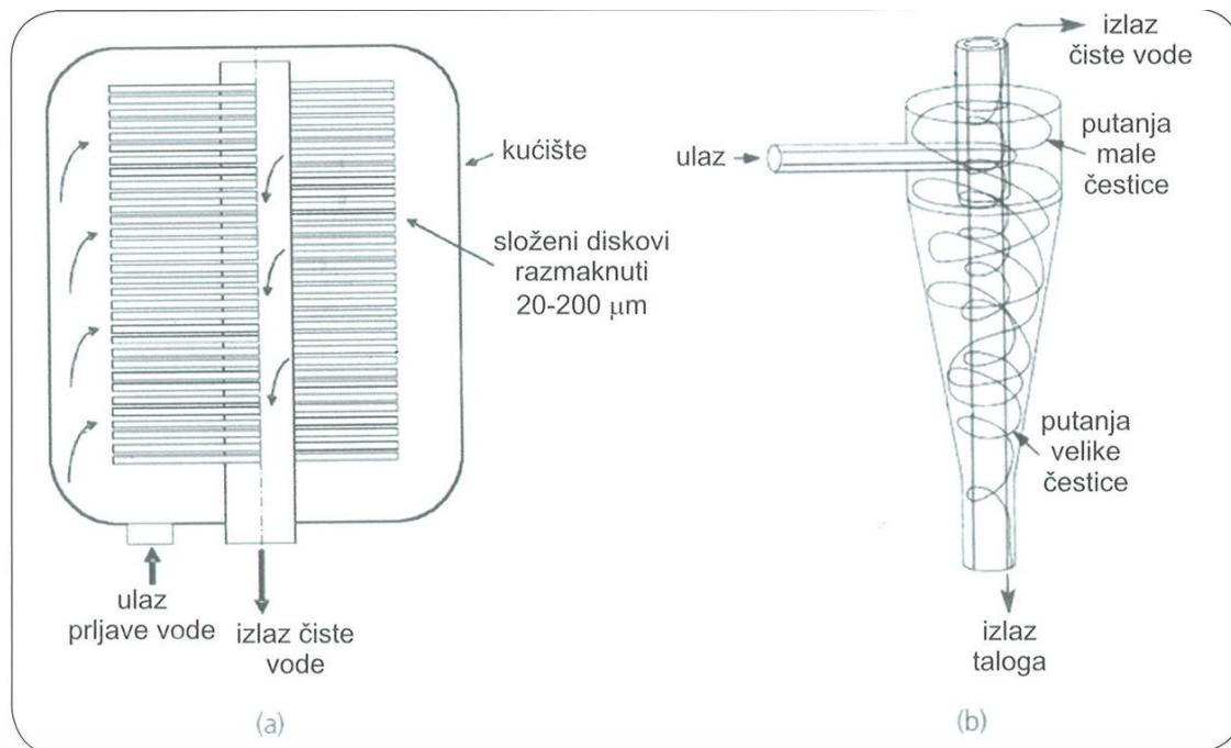
Slika 5. (a) Filtracija, i (b) Proces hidrociklone
