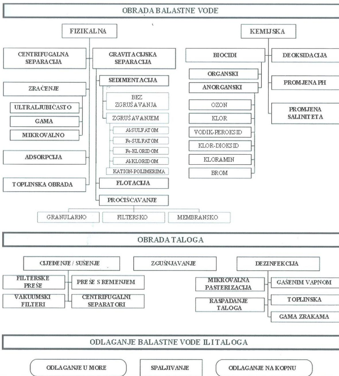
Slika 4. Prikaz različitih obrada balastne vode i taloga
