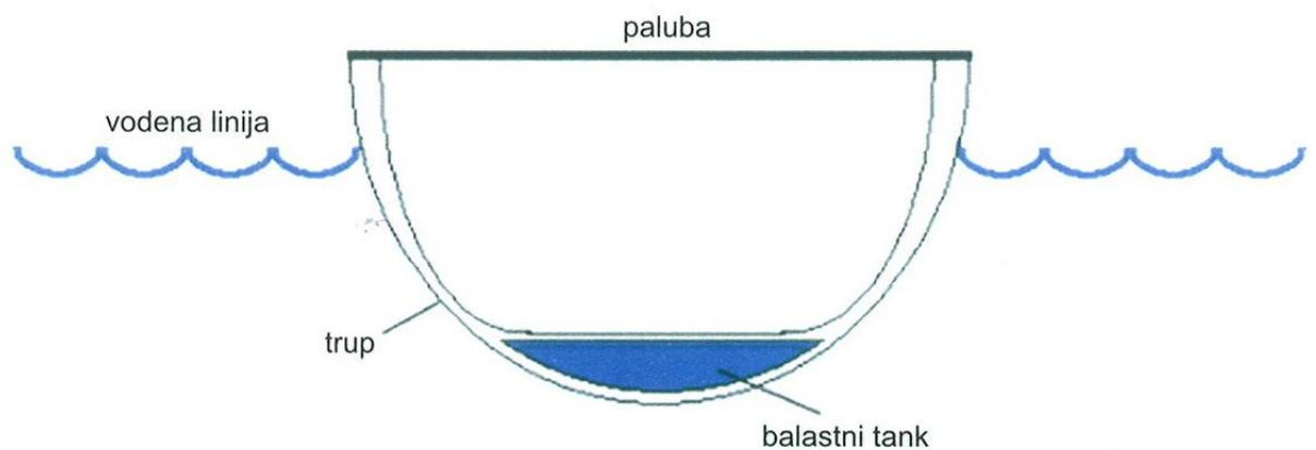
Slika 2. Presjek trupa broda s jednim balastnim tankom
