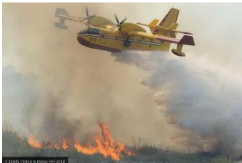
Sl. 11. Protupožarni amfibijski zrakoplov tipa Canadair CL-415 [20]
