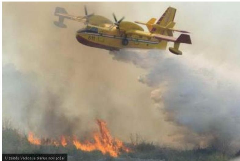
Sl. 11. Protupožarni amfibijski zrakoplov tipa Canadair CL-415 [20]
