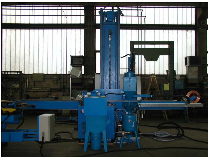
Slika 1.11. Fiksni nosač automata, EPP oprema za Ø 300
