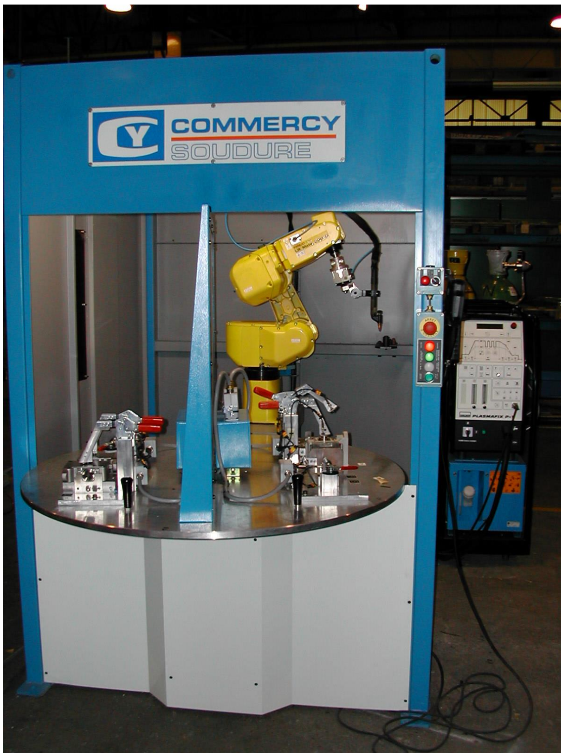
Slika 1.34. Robotska stanica s dva alata
