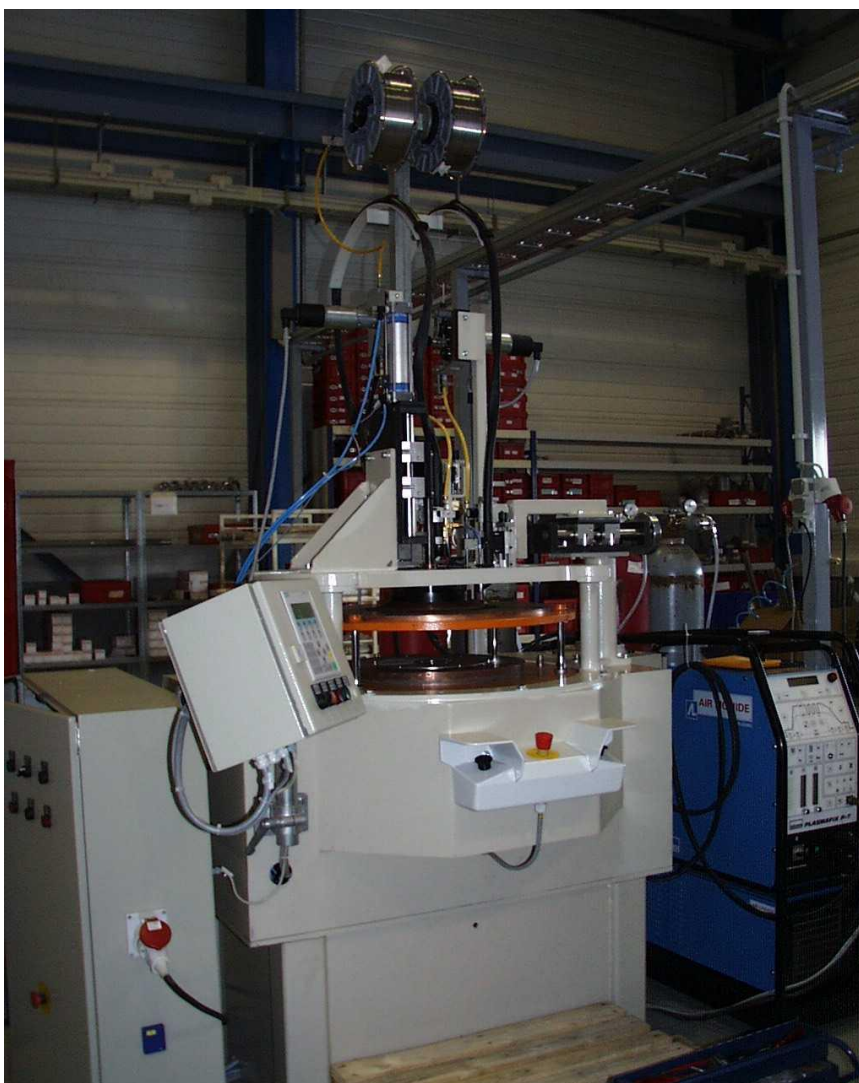
Slika 1.26. Automat za zavarivanje filter-elemenata, 2xTIG
