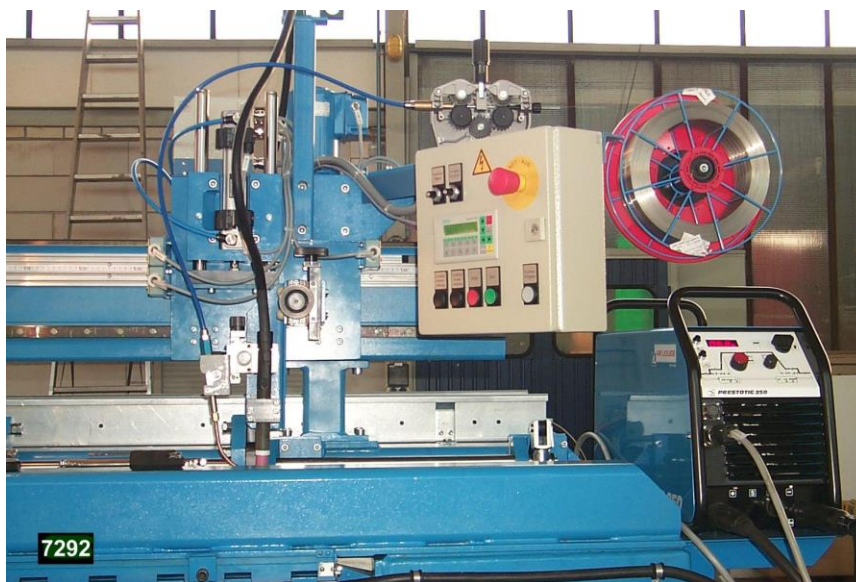
Slika 1.20. Uređaj za uzdužno stezanje i zavarivanje (vanjsko) s TIG+dodavanje žice
