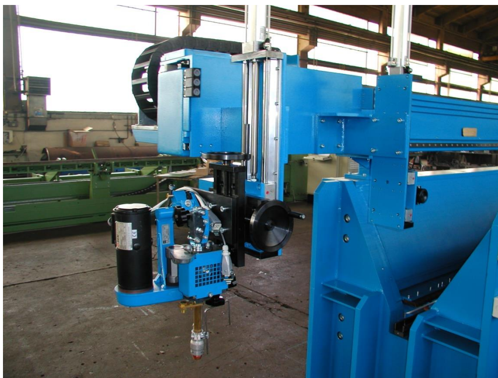
Slika 1.21. Uređaj za uzdužno stezanje i zavarivanje (r.lim 15÷40 mm, TIG+EPP)
