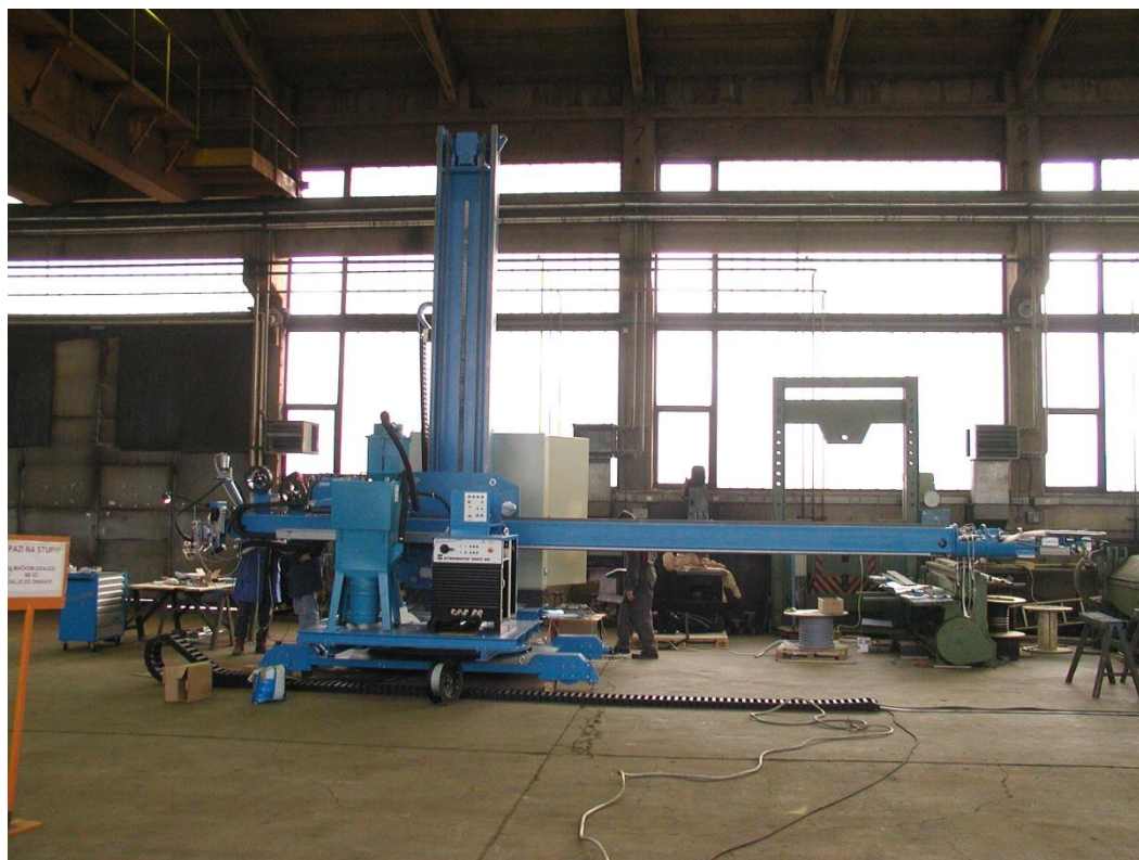
Slika 1.10. Nosač automata s TIG-om (lijevo) i EPP-om za min. Ø380 (desno)
