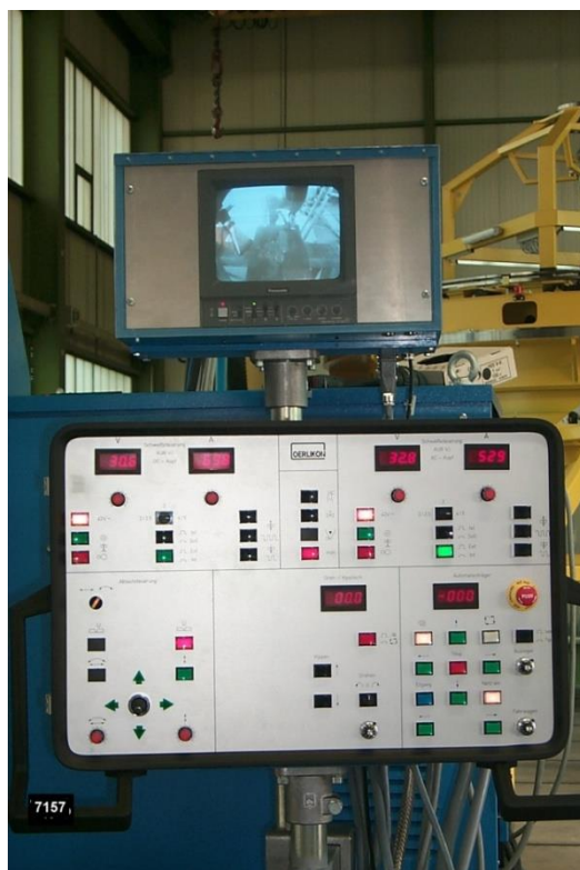
Slika 1.12. Dio komandnog pulta nosača
