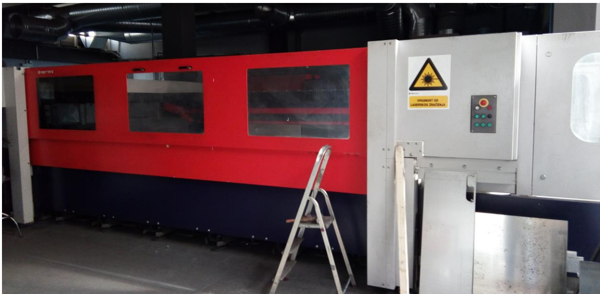
Slika 15. Zatvoreni dio, rezni prostor
