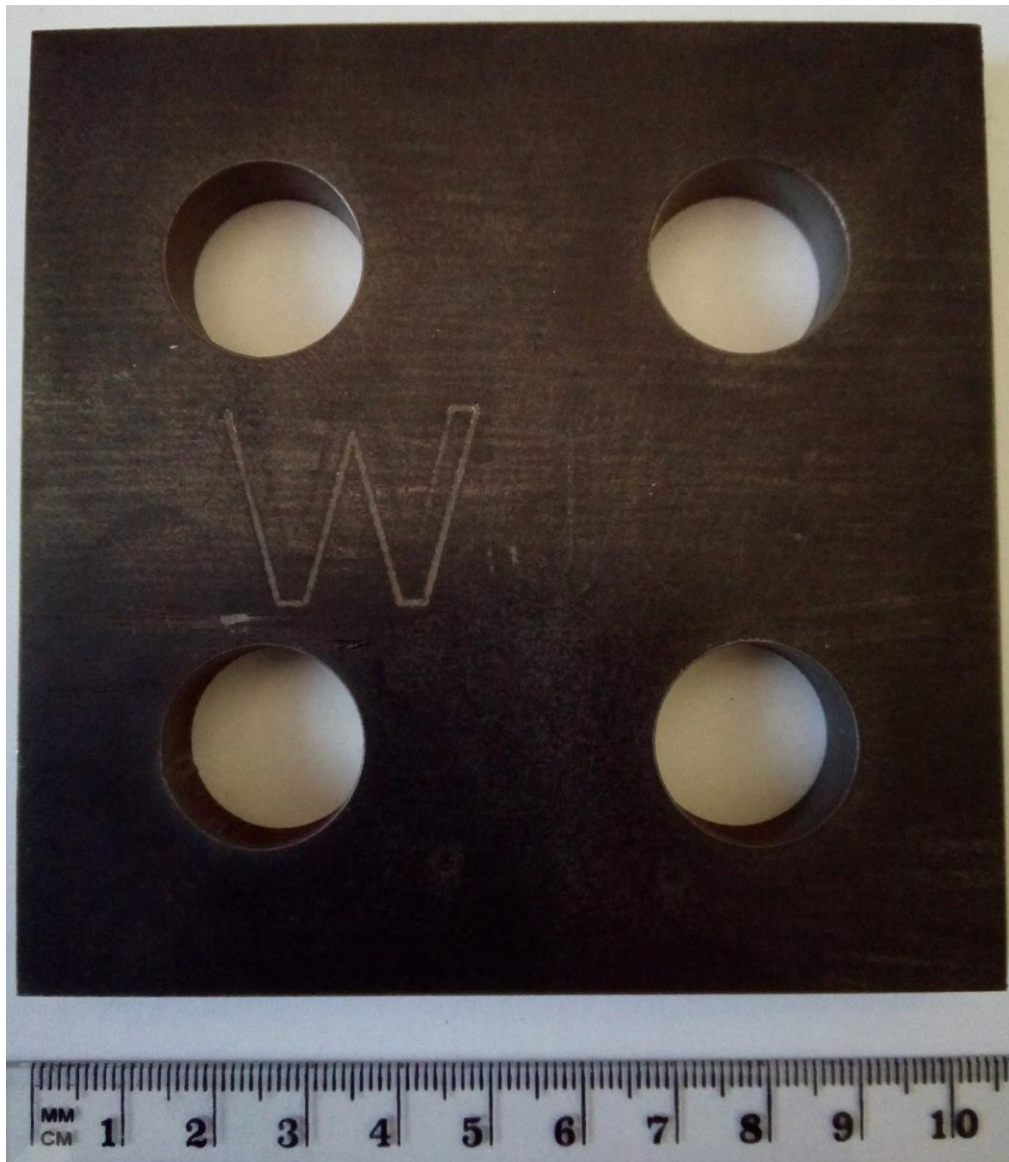
Slika 27. Obradak nakon obrade abrazivnim vodenim mlazom
