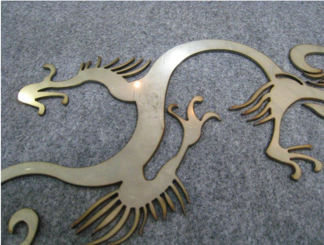
Slika 5. Primjer izratka nastalog obradom rezanja plazmom, [14]
