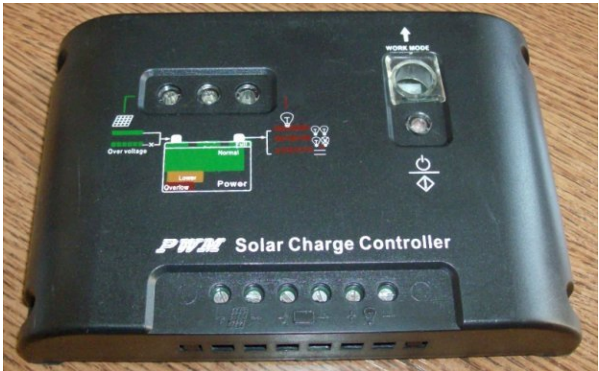
Slika 5. Predodžba solarnog regulatora punjenja
