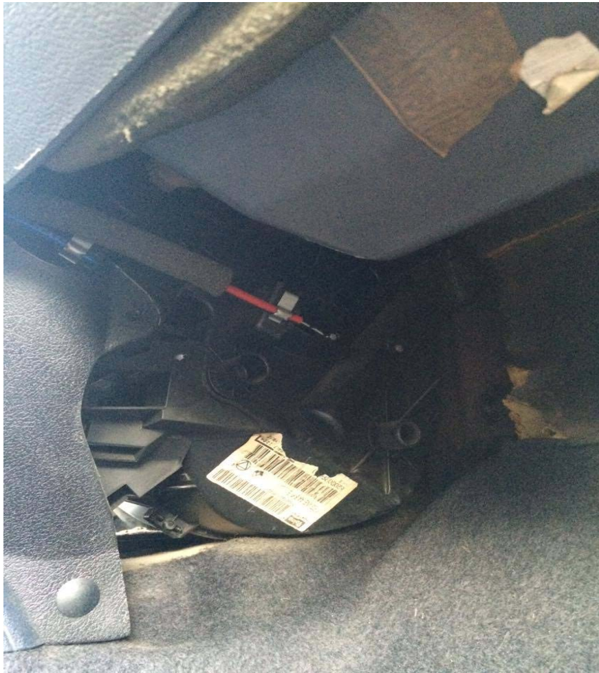
Slika 7. Predodžba mjesta ventilatora kabine ispod kontrolne table
