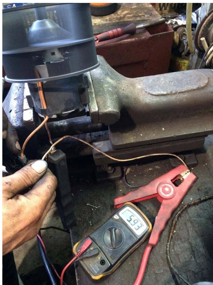
Slika 25. Predodžba mjerenja struje ventilatora
