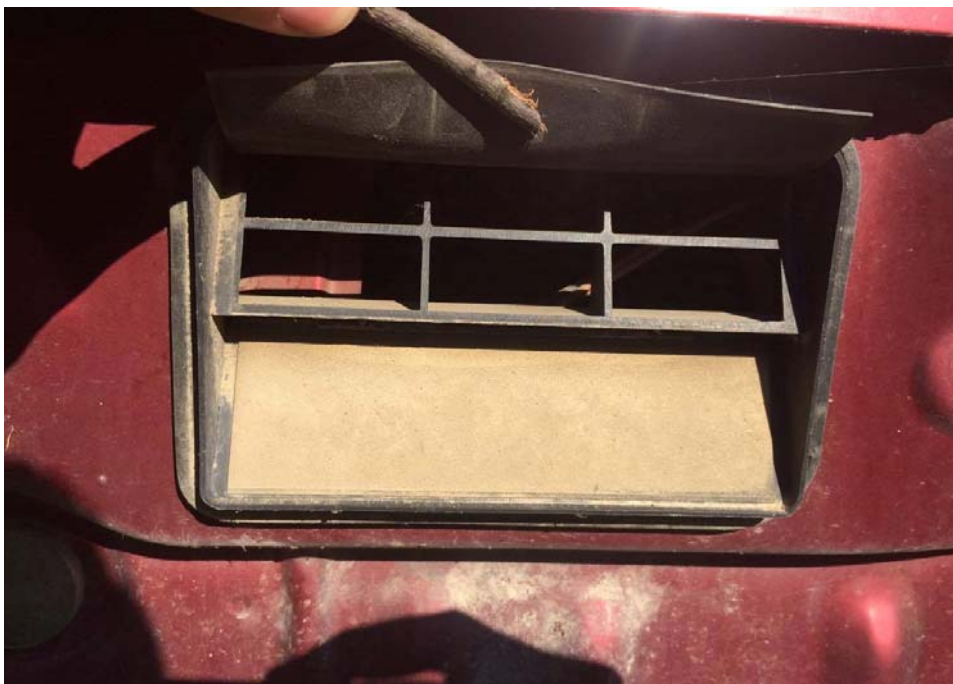
Slika 15. Predodžba tanke gumene zaštite na otvorima za izlaz zraka iz kabine
