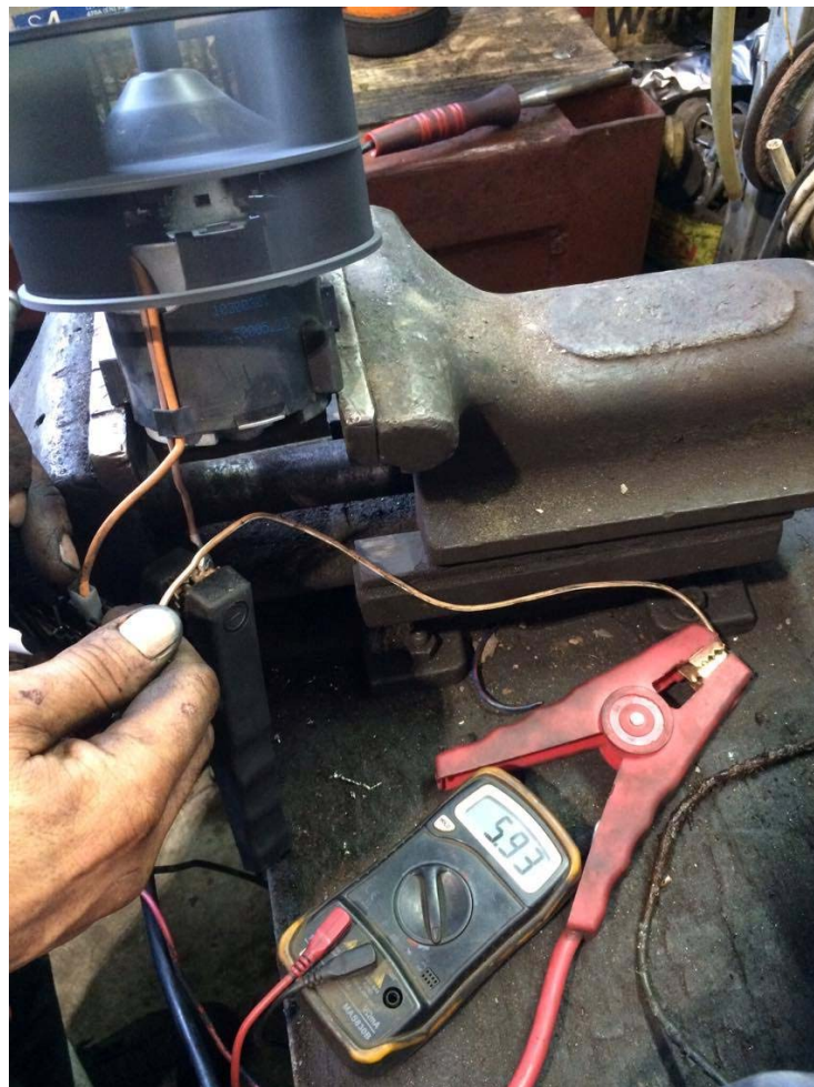
Slika 25. Predodžba mjerenja struje ventilatora
