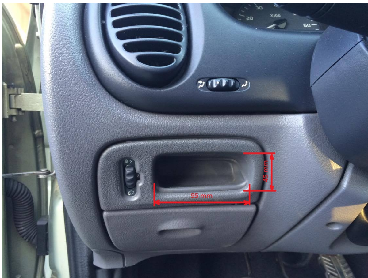
Slika 22. Predodžba prikladnog mjesta za ugradnju termoprekidača
