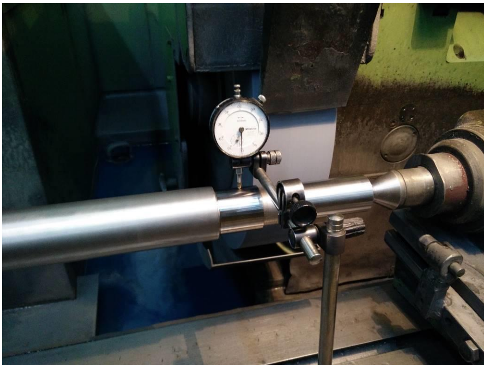
Slika 65. Kontrola radijalnih udara vratila
