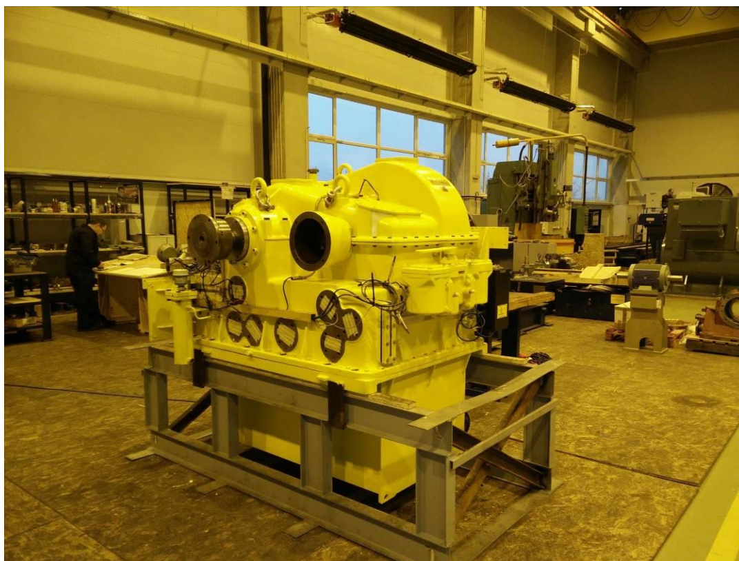
Slika 73. Hidrodinamička spojnica „Voith“
