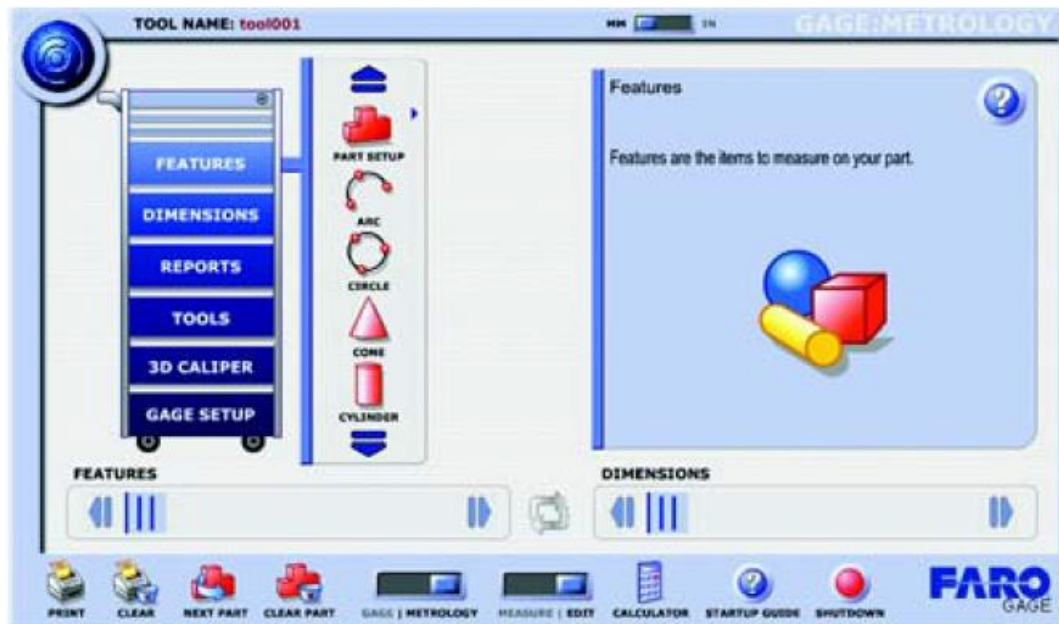
Slika 36. „Features“ ladica sa naredbama za mjerenje oblika [4]
