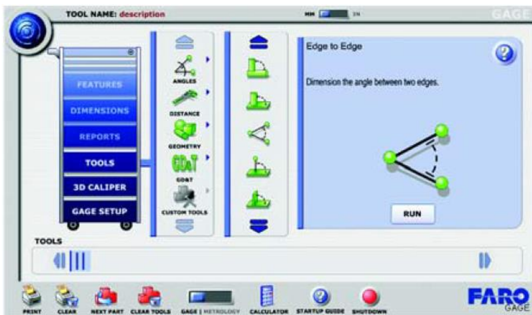
Slika 27. Odabir „Edge to Edge“ alata
