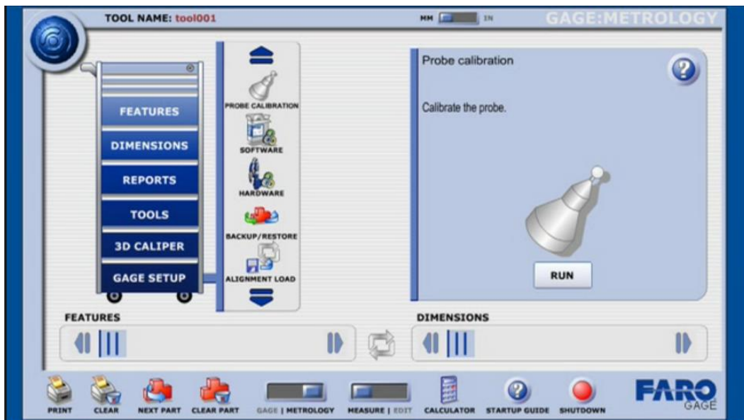
Slika 23. Odabir kalibracije mjernog ticala
