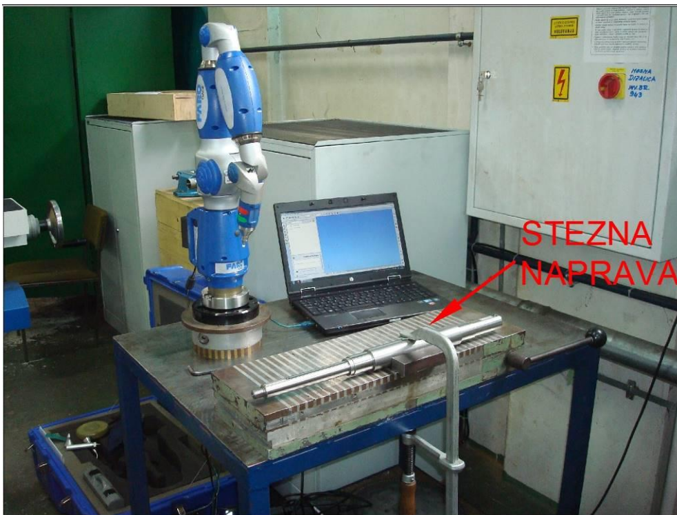
Slika 67. Vratilo spremno za kontrolu
