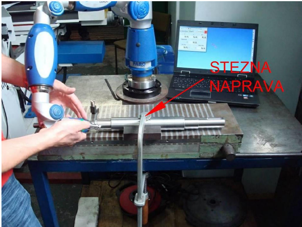
Slika 68. Dimenzionalna kontrola promjera vratila
