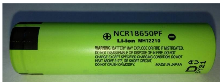
Slika 5. Li-ion članak baterije, tip NCR18650PF upotrebljen u izradi baterije za električni bicikl
