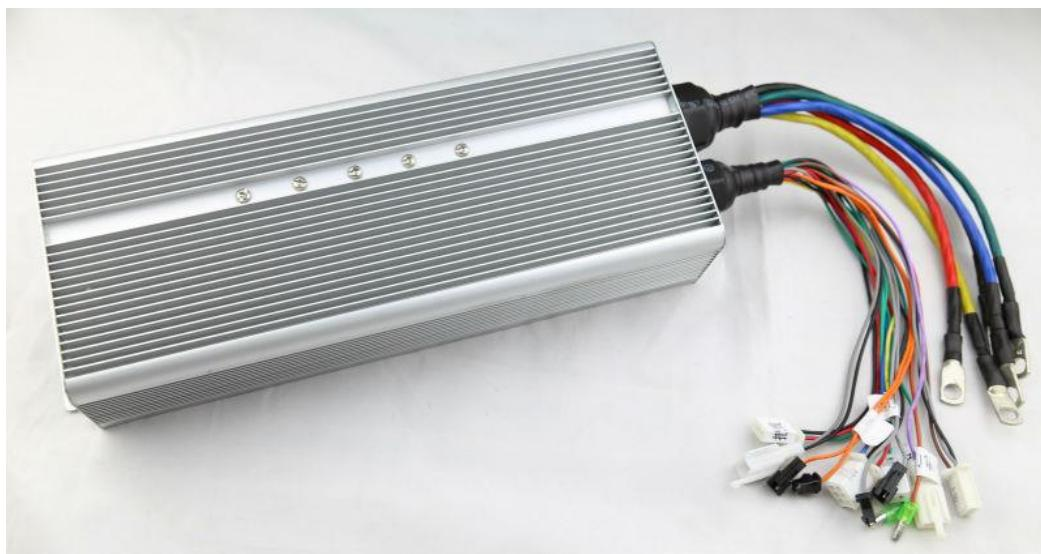
Slika 24. Kontroler BLDC motora
