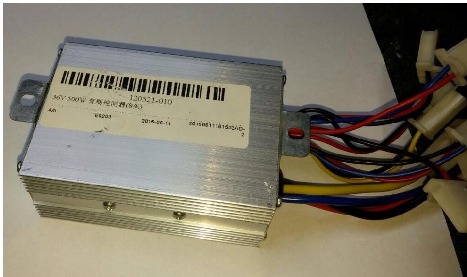
**Slika 23. PI regulator brzine vrtnje DC motora**
