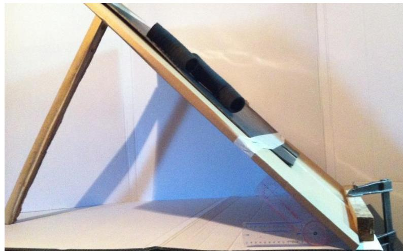
Slika 27. Trenje na kosini, eksperimentalno utvrđivanje [14]
