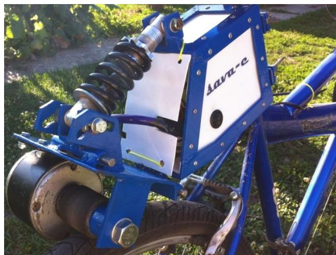
Slika 39. Modularni sklop montiran na bicikl
