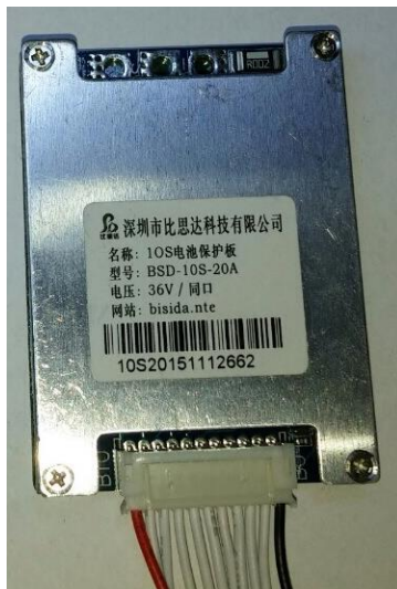
Slika 13. BMS, upravljački elektronički sklop baterije
