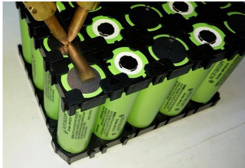
Slika 9. „Točkasto“ zavarivanje
