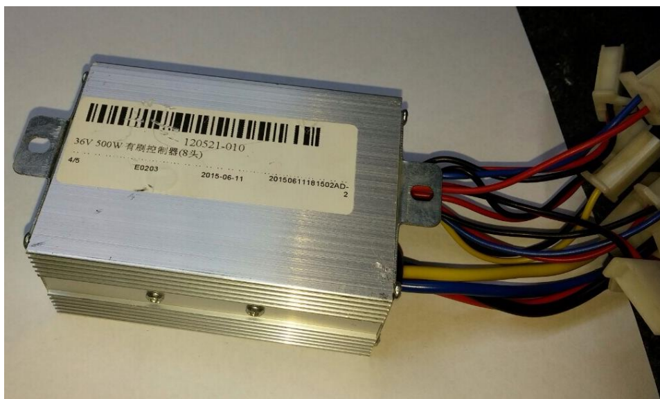
Slika 23. PI regulator brzine vrtnje DC motora
