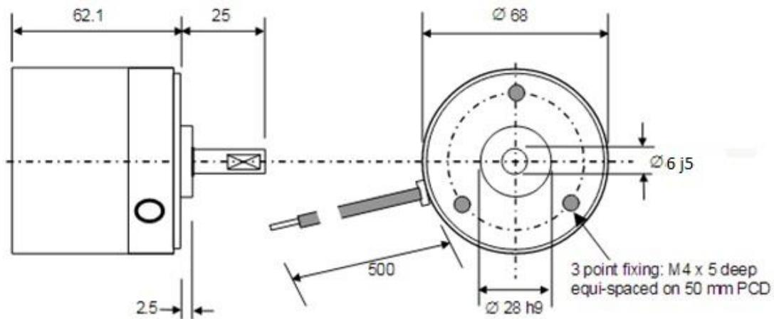
**Slika 20. Gabaritne mjere BLDC motor, model BLDC58-50L**
