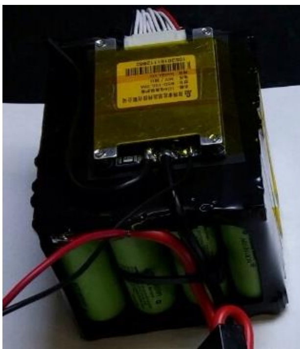
Slika 14. Bateriajski sklop sa BMS-om
