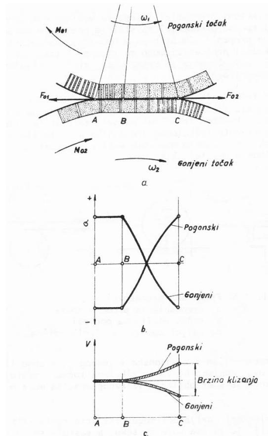
Slika 33. Elastično klizanje; a) tangentna dodira tarenica, b) tok naprezanja površinskih slojeva, c) tok brzina tarenica [5]
