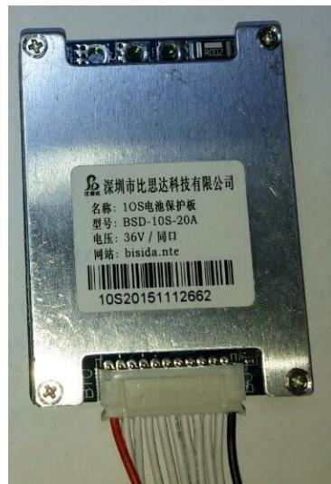
Slika 13. BMS, upravljački električki sklop baterije
