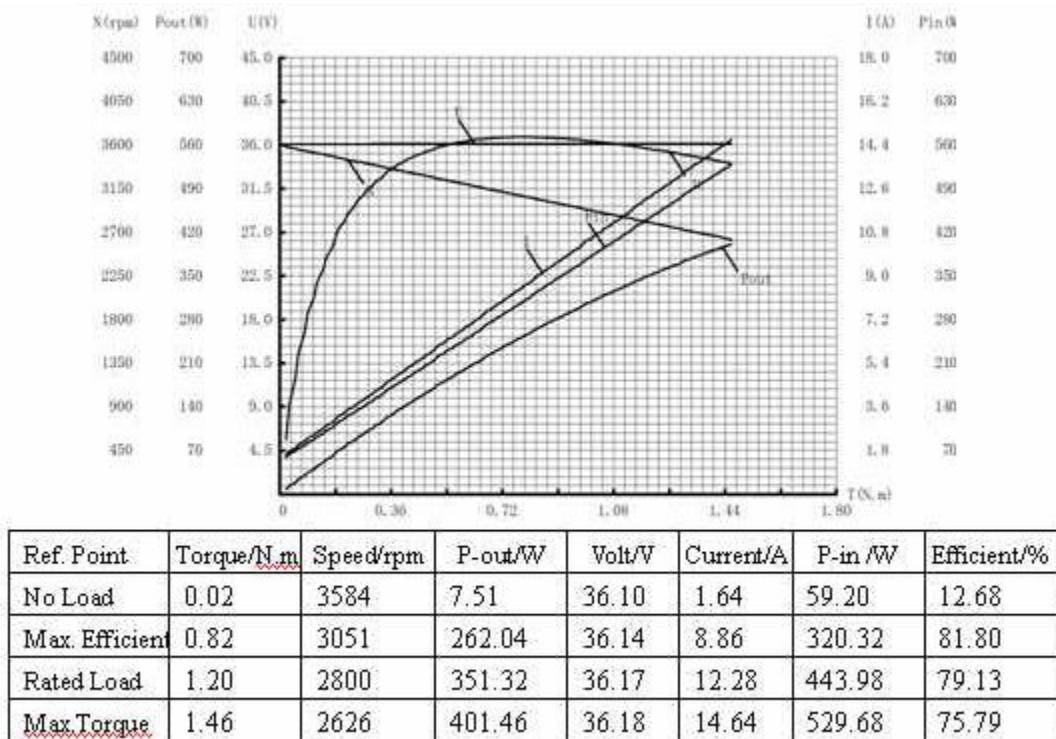
**Slika 18. Dijagram DC motora zavisnosti snage-broja okretaja-napona-struje-okretnog momenta [11]**
