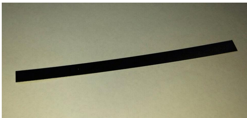
Slika 8. Traka od nikla za povezivanje članaka
