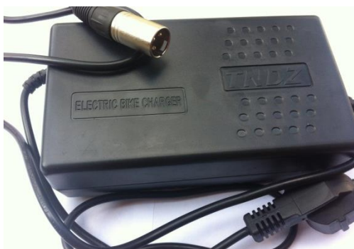
Slika 15. Punjač baterije napona 36V, stuje 3A
