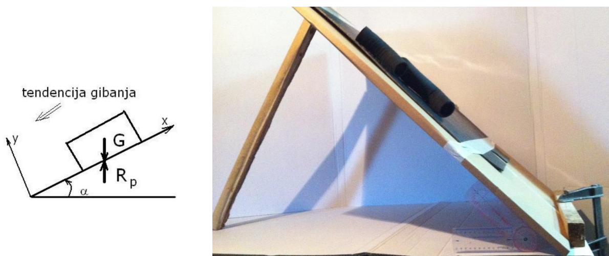
Slika 27. Trenje na kosini, eksperimentalno utvrđivanje [14]
