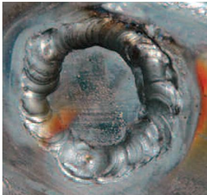
Slika br.13. Primjer ispunjavanja rupe zavarom
