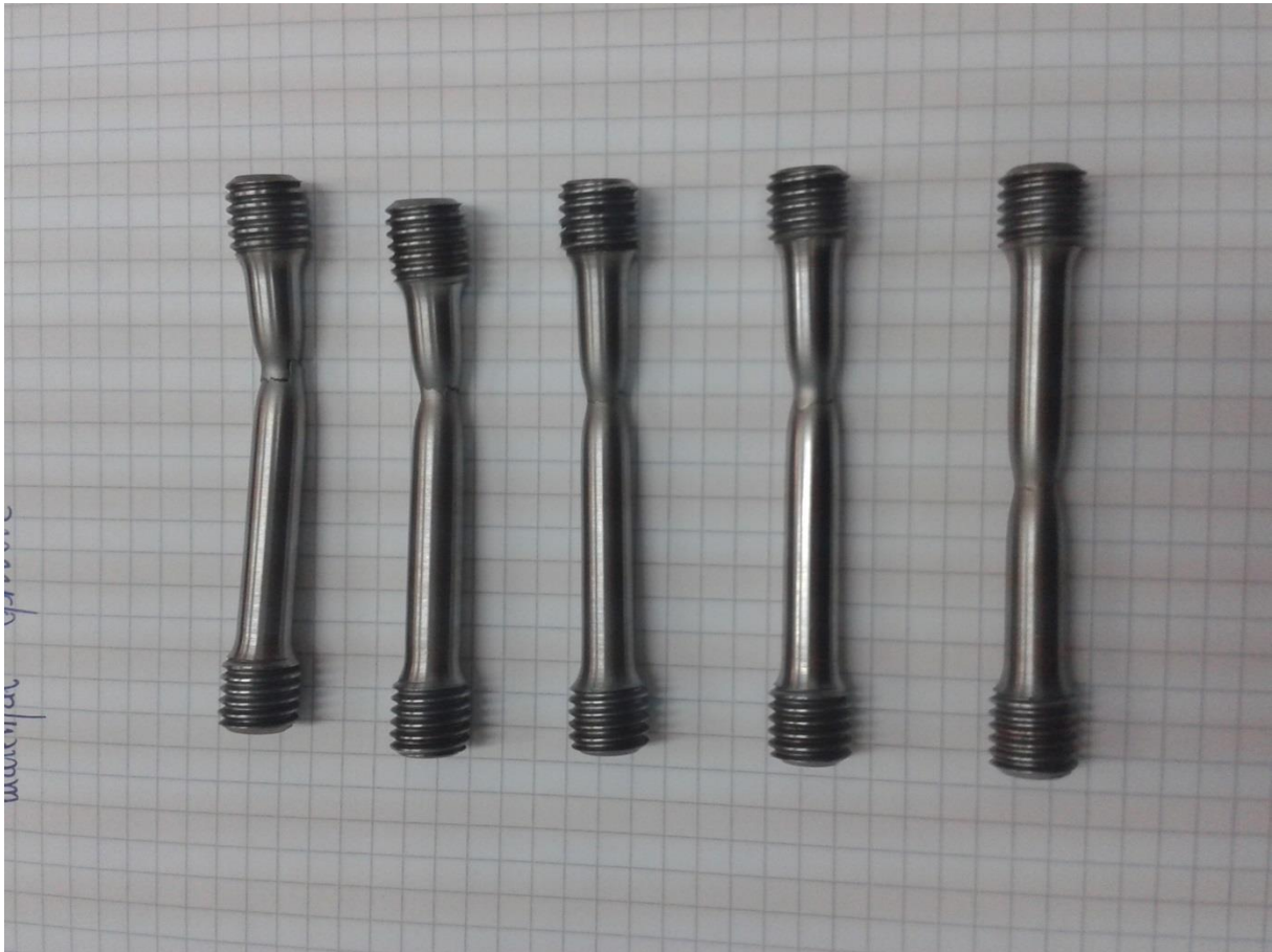
Slika 16. Epruvete s ispitivanja (nakon loma)
