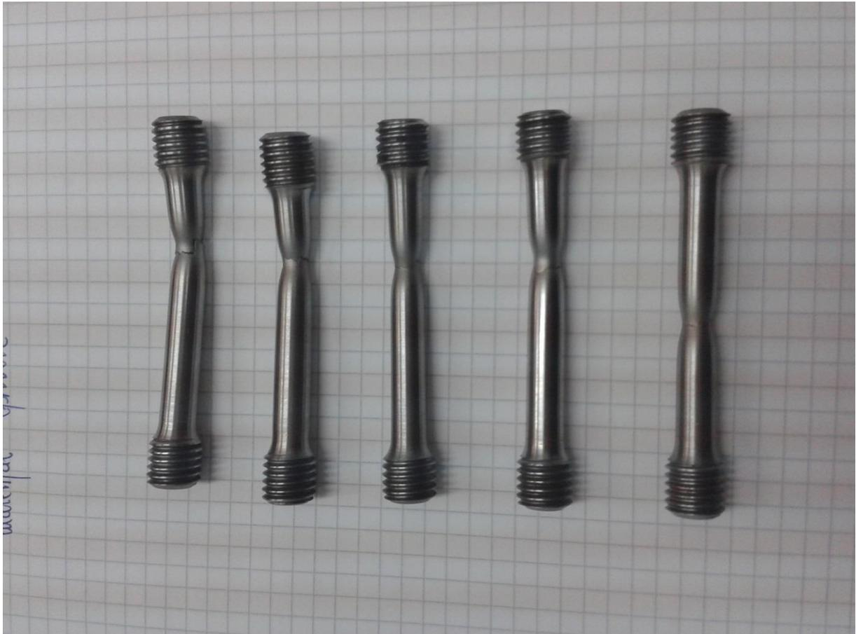
Slika 16. Epruvete s ispitivanja (nakon loma)
