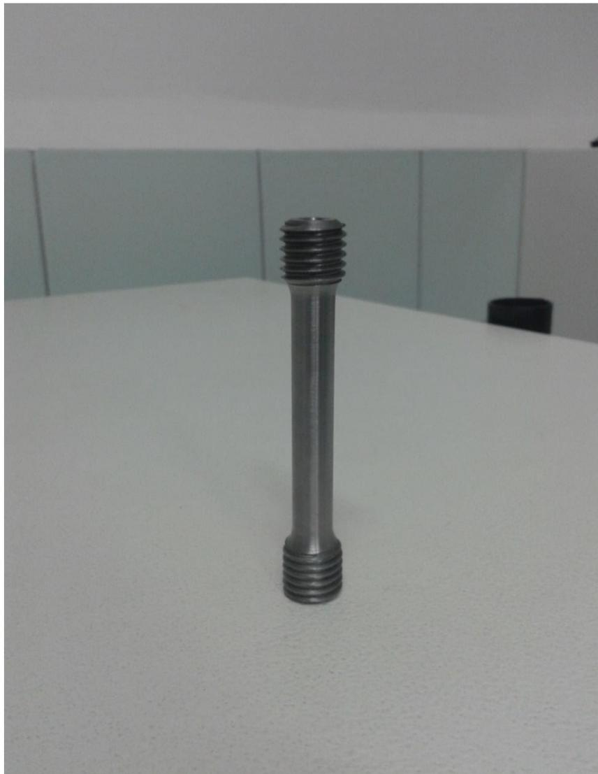
Slika 15. Epruveta s ispitivanja (prije loma)
