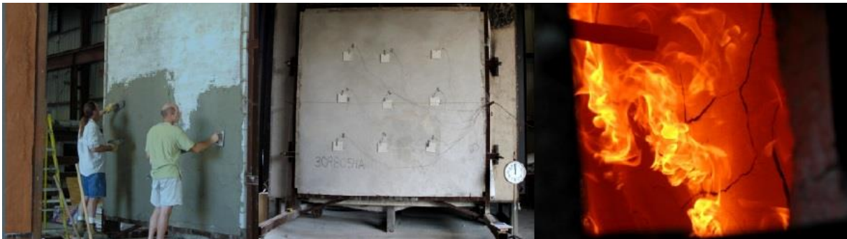
Sl. 9. Zid od balirane slame na početku ispitivanja, u sredini strana koja nije izložena vatri a sa desne je izložena strana zida [9]
