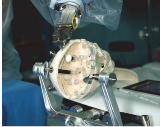
Slika 34. Predodžba fiksiranog fantoma lubanje Mayfield hvataljkom. Izvor: http://stariweb.mef.hr/
