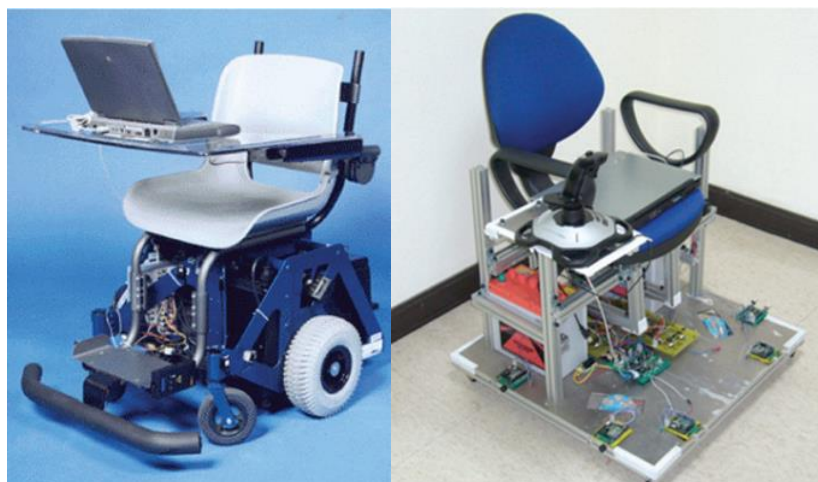
Slika 25. Predodžba robotiziranih invalidskih kolica. Izvor: http://www.hrcak.srce.hr/
