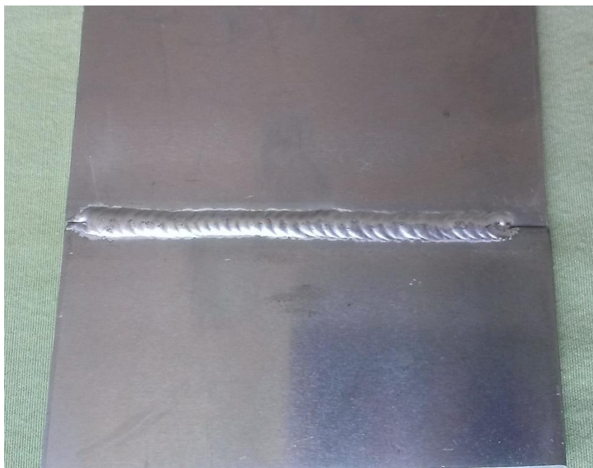
Slika 27. Uzorak zavaren MIG postupkom
