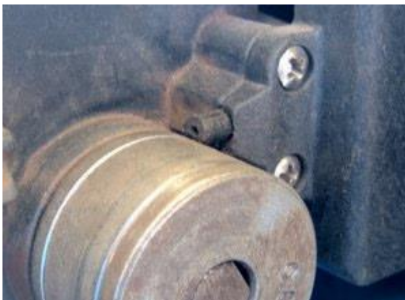
Slika 17. Ulaz žice kroz teflonsku vodilicu
