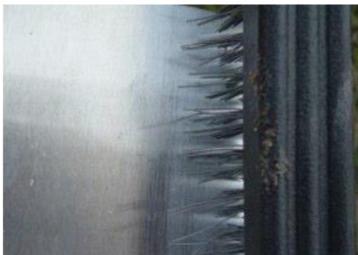
Slika 14. Čišćenje mjesta zavara četkom
