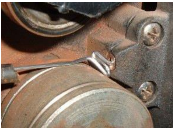
Slika 16. Pritisak valjaka prevelik.
