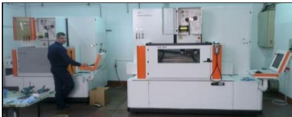
Slika 21. Erozimati na žicu
