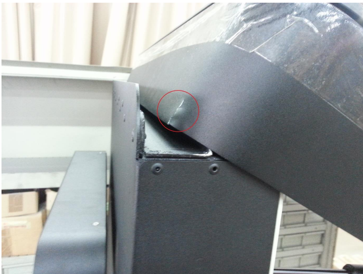
Slika 45. Pukotina na zavarenom spoju.
