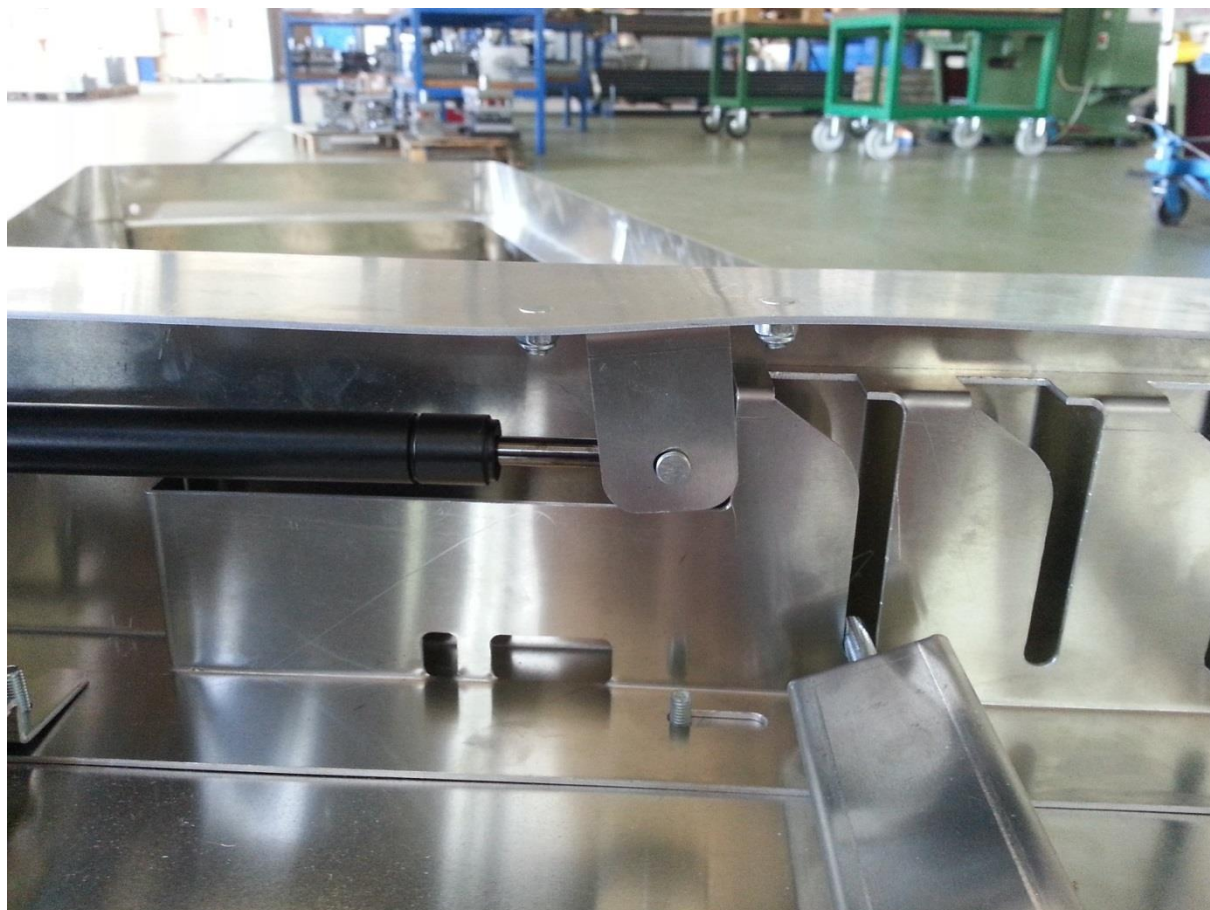
Slika 44. Kod ugradnje amortizera došlo je do uvijanja vanjskog okvira. Da bi riješili problem bilo je potrebno drugačije izvesti nosač amortizera, te ojačati vanjski okvir.
