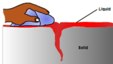
Slika 33. Uklanjanje viška penetranta.
