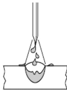
Slika 7. Shematski prikaz prijenosa metala prijelaznim lukom [3]
