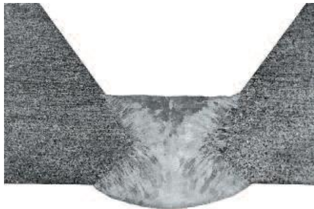
Slika 12. Izbrusak korijenskog prolaza zavara; Zavarivanje je izvedeno STT postupkom zavarivanja [8]
