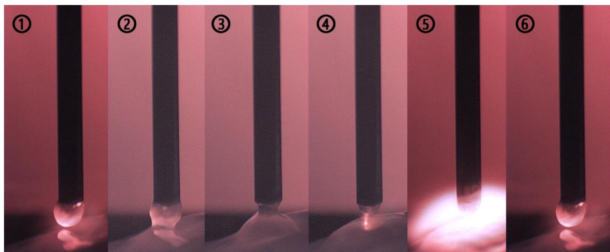
Slika 22. Prijenos kapljice metala tijekom STT postupka zavarivanja [7]
