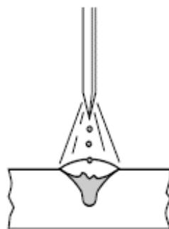
Slika 8. Shematski prikaz prijenosa metala štrcajućim lukom [3]
