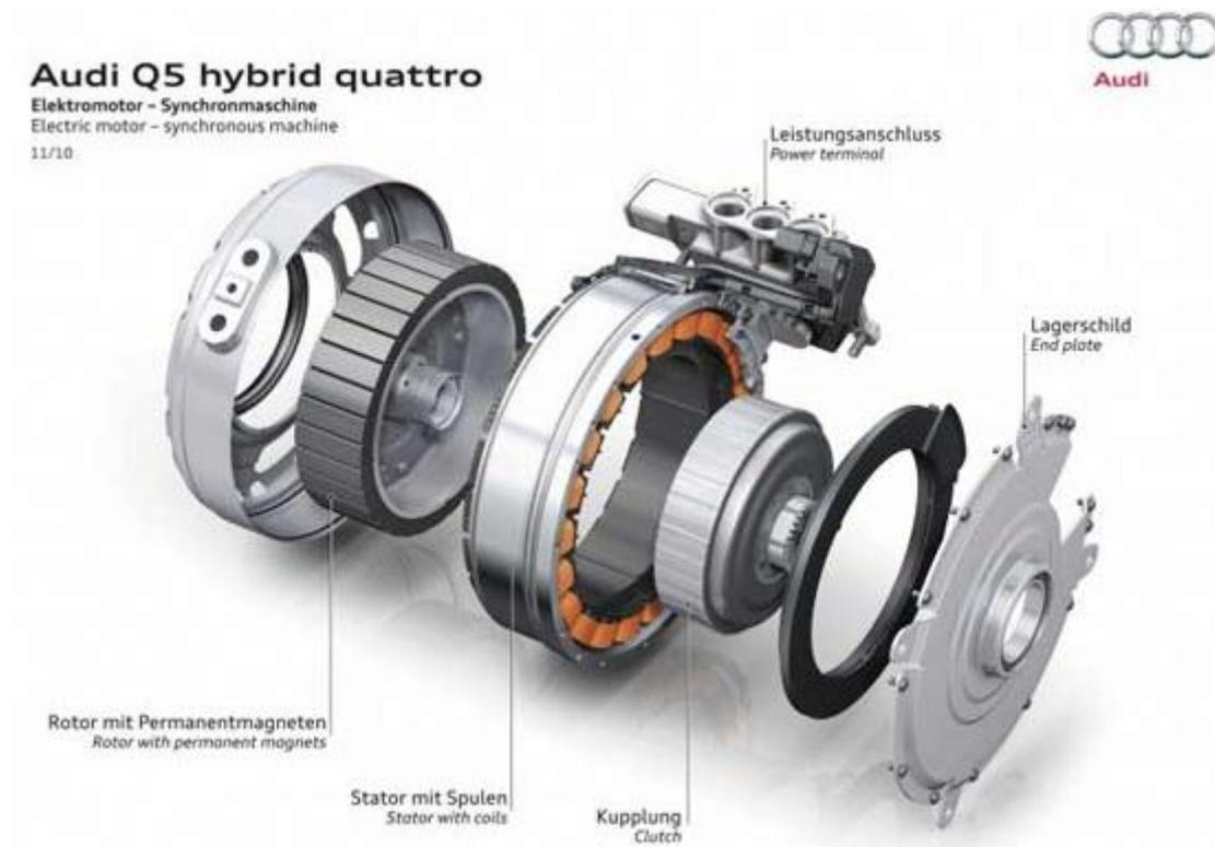
Slika 8. Primjer elektromotora hibrida Audi Q5 Quattro[7]
