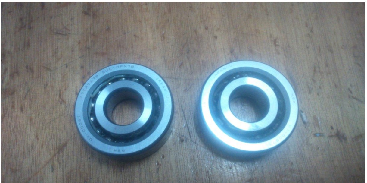
Slika 24: Novi ležaji s kosim dodirom
