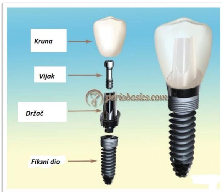
Slika 24. Komponente višedijelnih dentalnih implantata [18]
