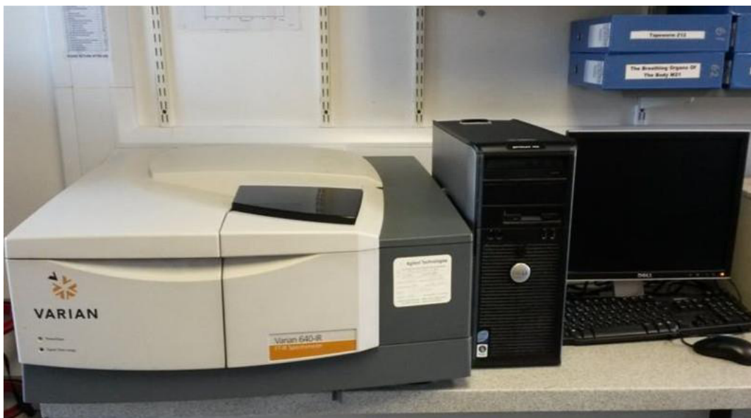
Slika 11. FT-IR analizator ulja, model 640 (Varian)
