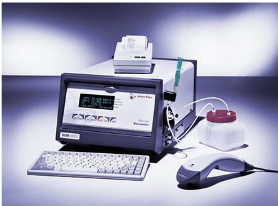
Slika 10. Stabinger-viskozimetar SVM 3000 (Anton Paar)
