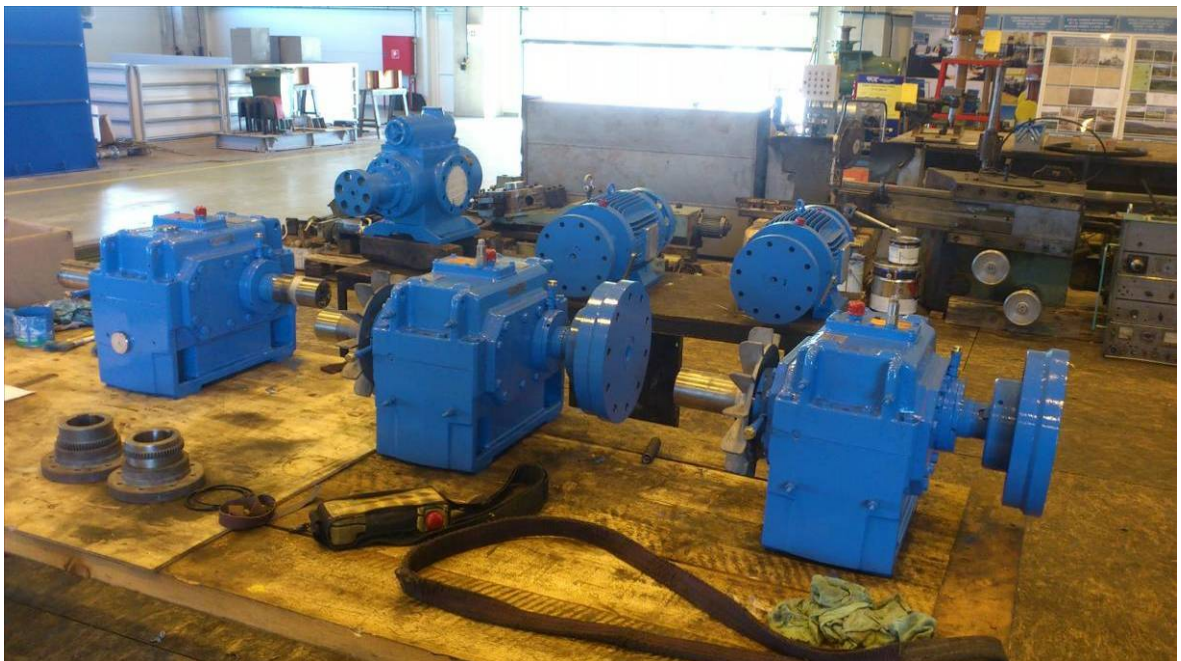
Fotografija 4.4 Podmontaža reduktora i uključno-isključne spojke
