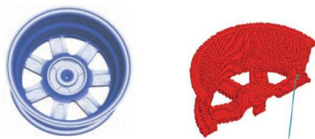
Slika 46. Prikaz 3D modela (lijevo) te prikaz aluminijskog odljevka u mreži (desno).
