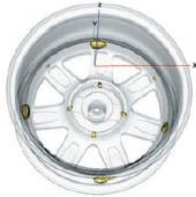
Slika 54. Prikaz grešaka uslijed skrućivanja nakon prisilnog hlađenja.
