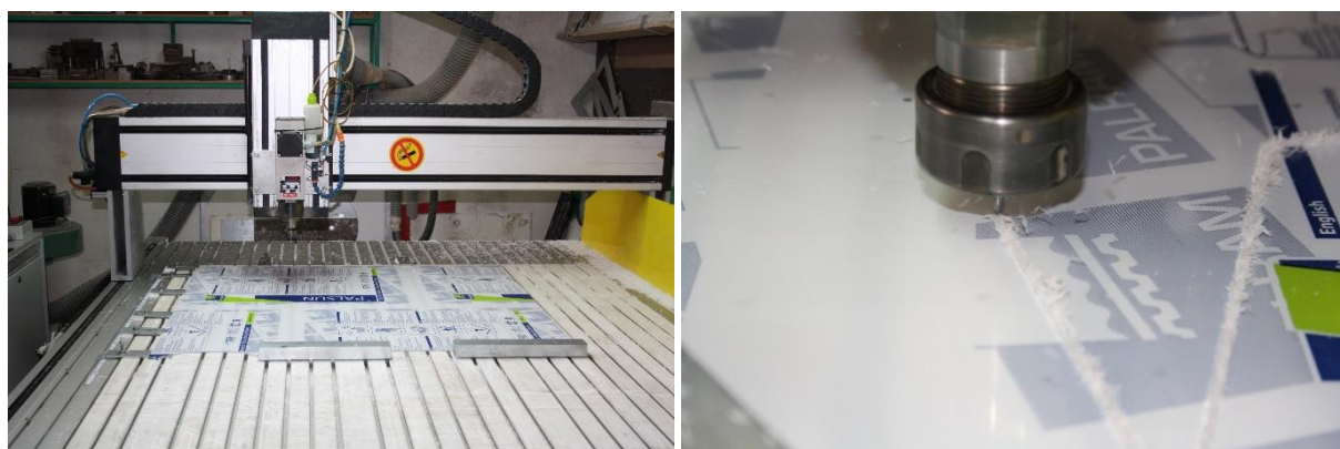
Slika 35 Rezanje pločice za napajanje na CNC-u glodalici
