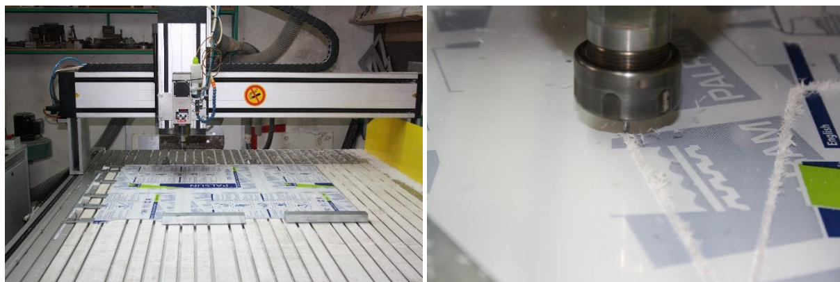
Slika 35 Rezanje pločice za napajanje na CNC-u glodalici
