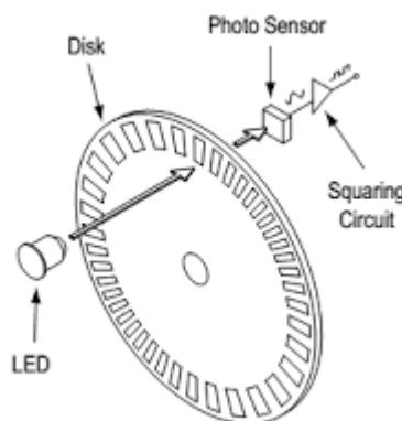
**Slika 7. Inkrementalni enkoder**
