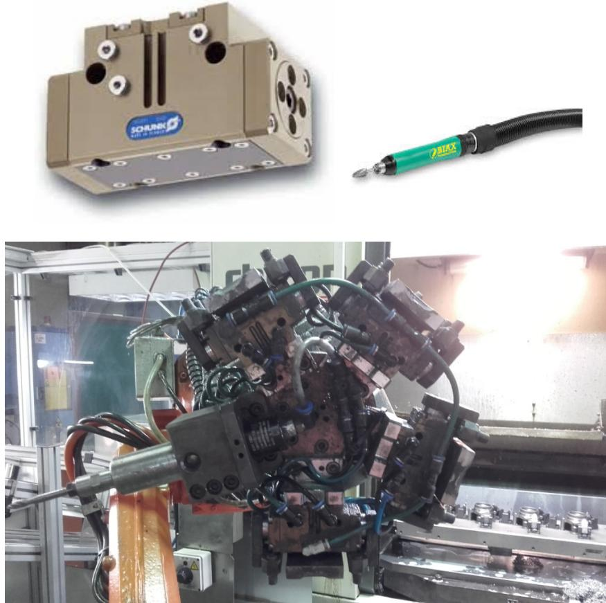
Slika 2. Griper (lijevo), Bijax (desno) i kompletan griper u čeliji (dolje)
