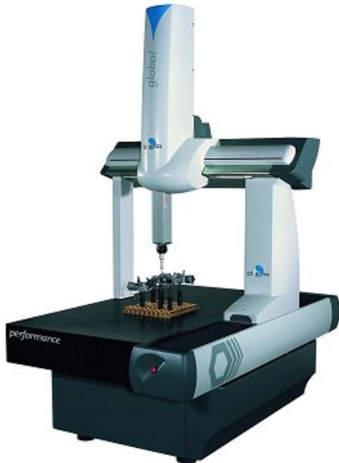
**Slika 41. DEA – uređaj za mjerjenje obrađenih komada**
