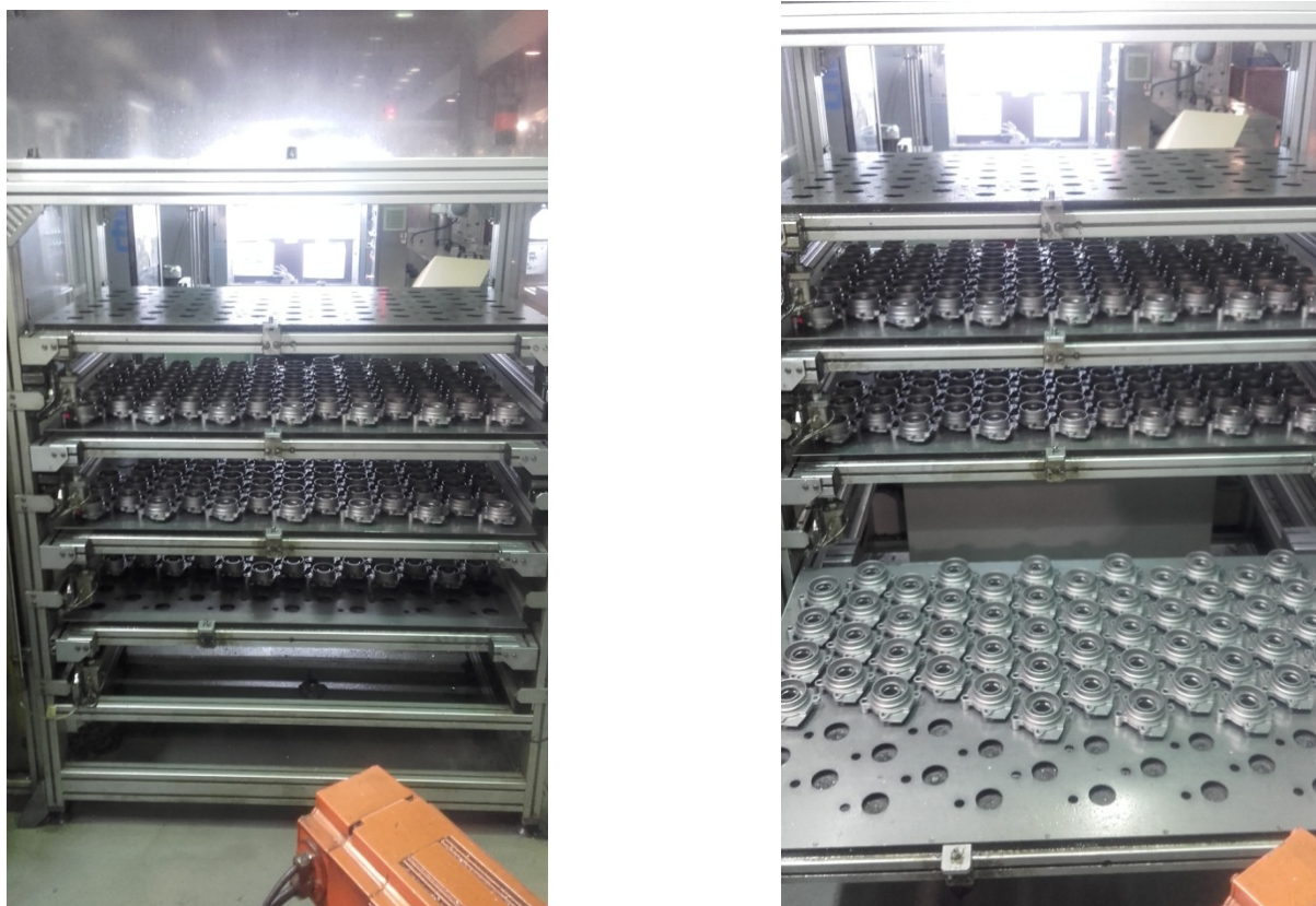
Slika 24. Prikaz ormara za pripremu surovaca
