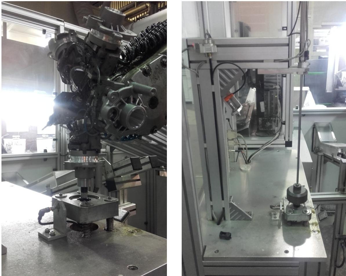
Slika 30. Prikaz mjerena komada i kalibriranja mjernog trna
