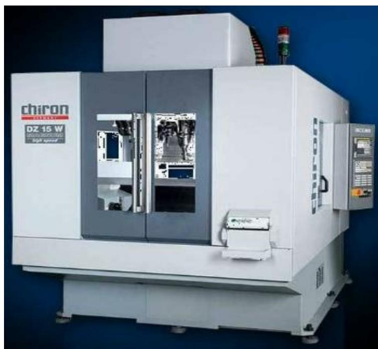
Slika 13. Glodaći obradni centar
