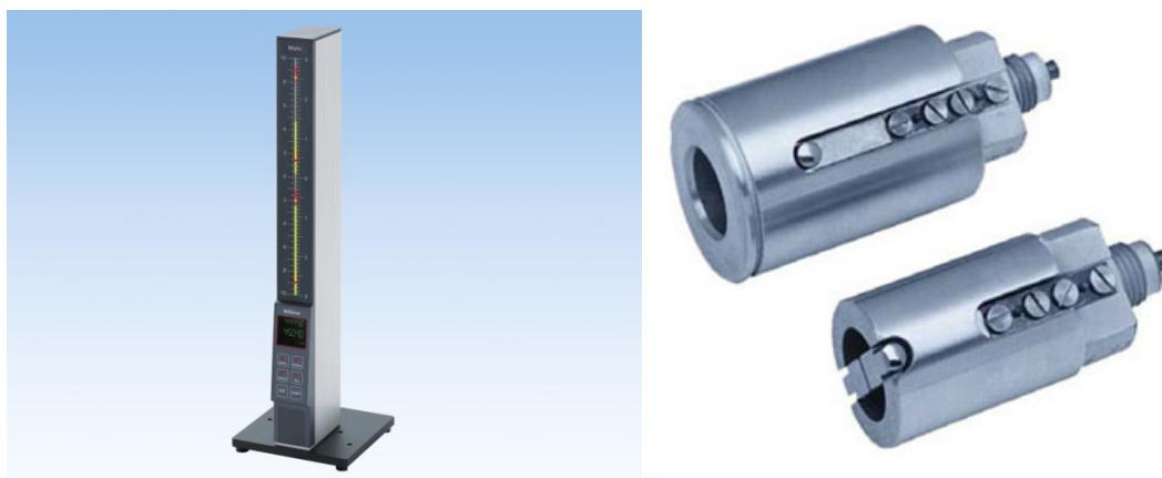
Slika 29. Prikaz milimara (lijevo) i mjernog trna (desno)
