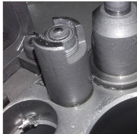
**Slika 15. Prikaz mikroprekidača za kontrolu nalijeganja komada**
