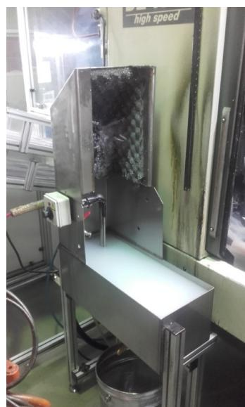
**Slika 28. Prikaz kade za ispiranje i ispuhivanje obrađenih komada**
