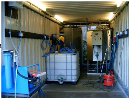
Slika 24: Malo postrojenje za proizvodnju biodizela
