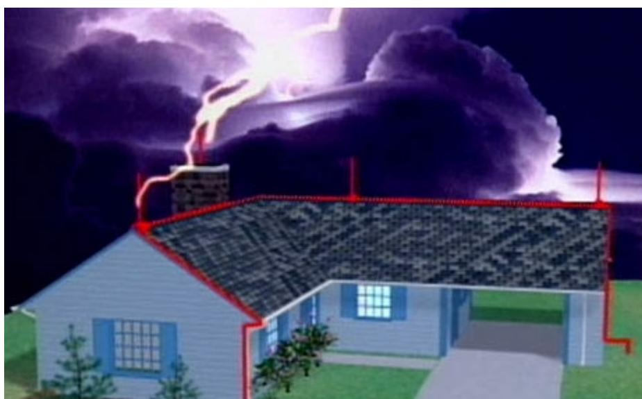
Slika 2. Udar groma u građevinu na kojoj je instalirana gromobraska zaštita [6]
