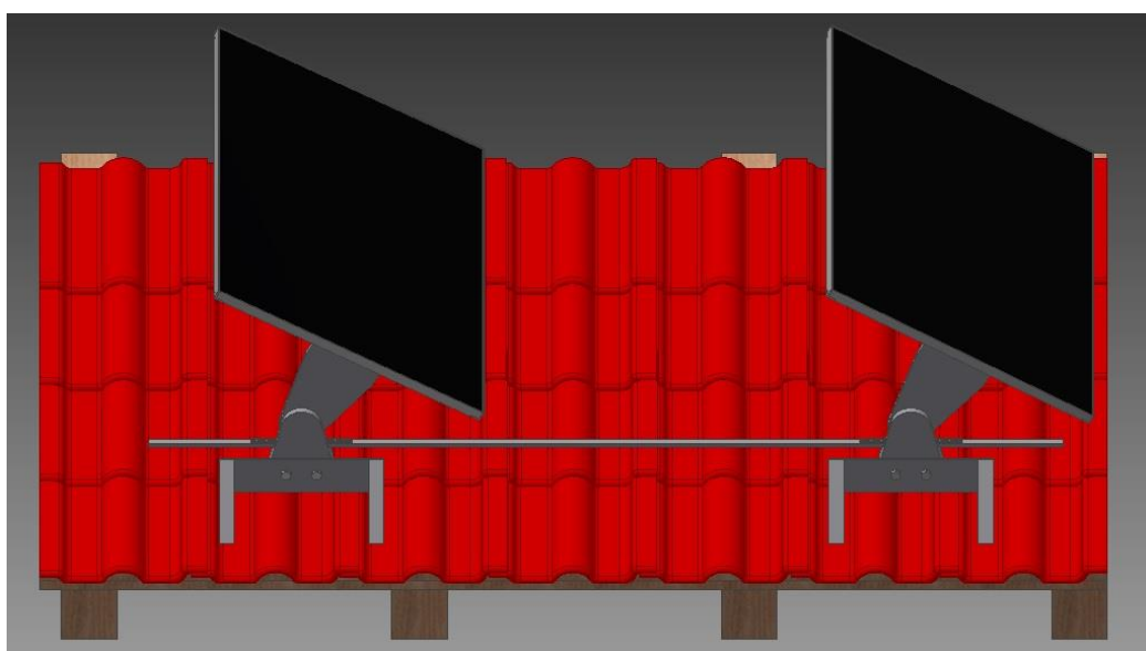
Slika 24. Predodžba zakreta solarnog sustava za 30° (izvorno)
