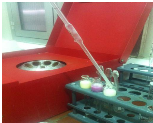
Slika 7. Određivanje udjela masti u sladolednoj smjesi metodom po Gerberu (Ledo d.d., 2016)
