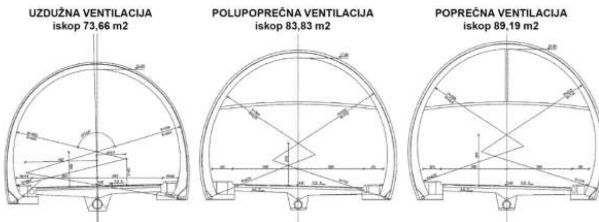
Slika 7. Poprečni presjeci ovisno i tipu ventilacije [6]
