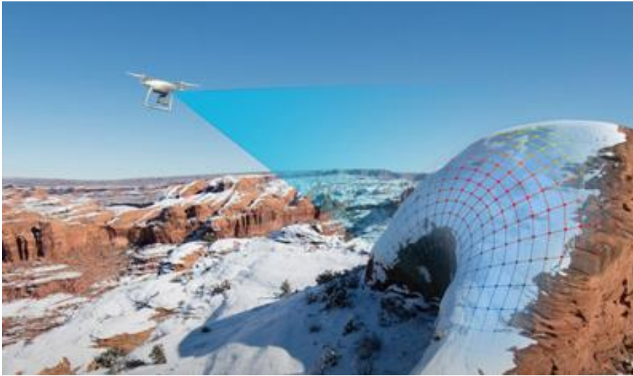
Sl. 26. Senzor za izbjegavanje prepreka [33]
