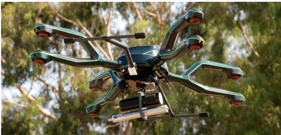
Sl.8. Drone-RAD detektor [16]
