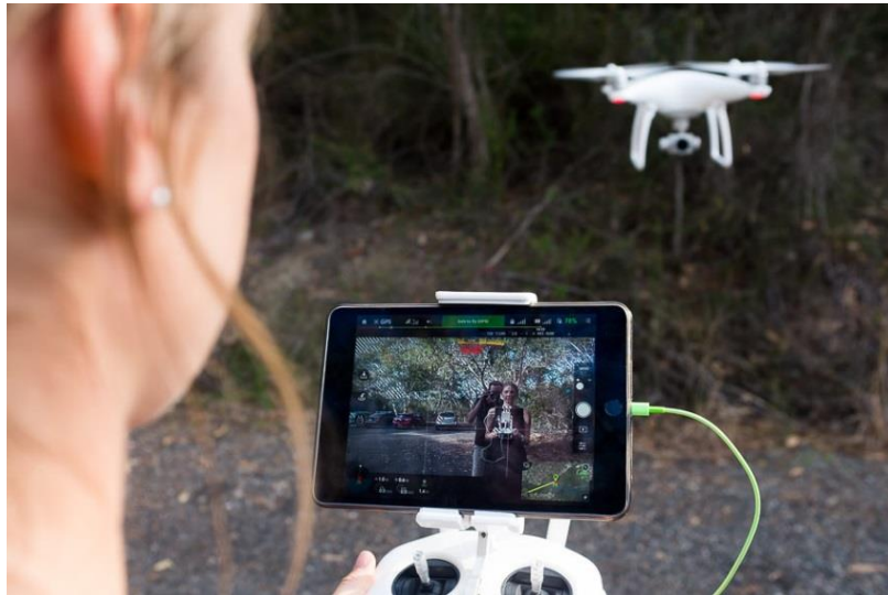
Sl. 24. Uređaj tablet kao platforma zemaljske stanice [34]
