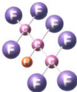
Sl. 21. Prikaz molekule plina FM-200, odnosno \text{CF}_3\text{CHF}_2\text{CF}_3
