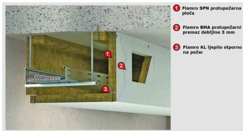
Sl. 8. Prikaz zaštite instalacije postavljanjem u poseban protupožarni kanal [13]
