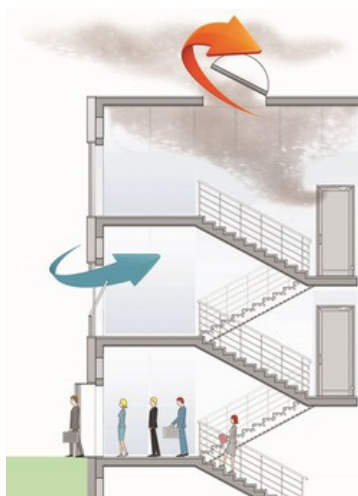
Sl. 11. Prikaz primjera sustava odimljavanja
