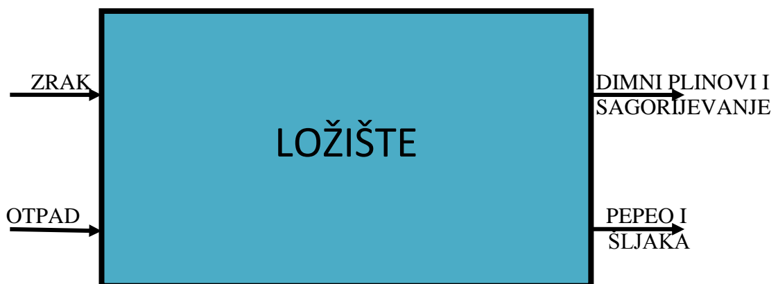
Slika 11. Shema sagorijevanja otpada
