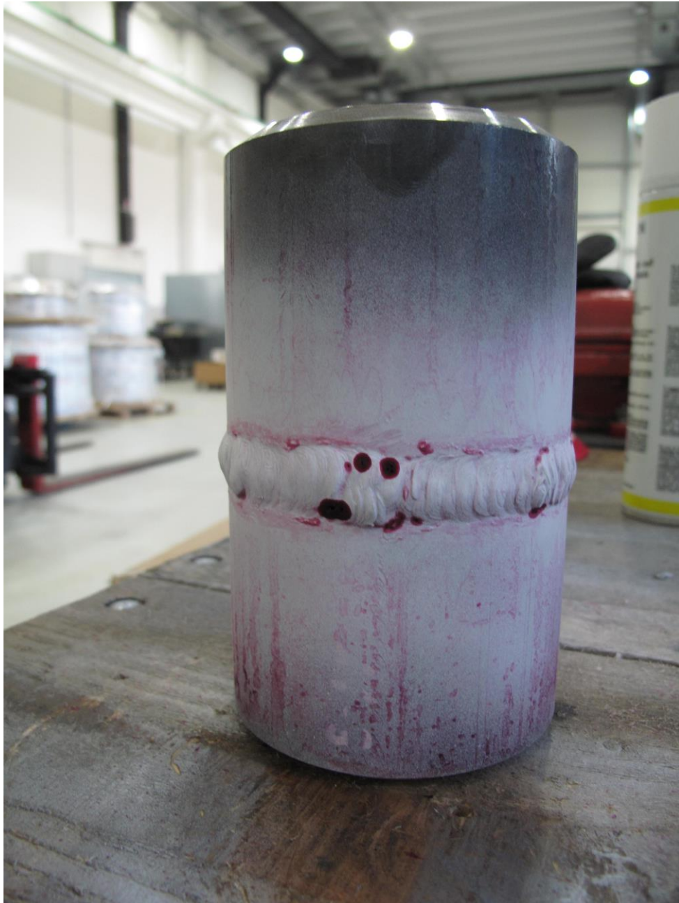
Slika 33. Stvaranje penetrantskih indikacija
