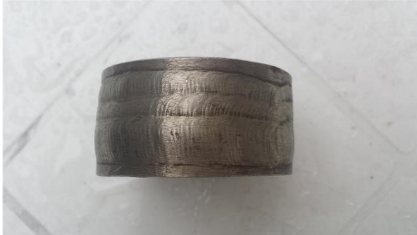
Slika 11. Pregled zavarenog spoja Vizualnom kontrolom [11]
