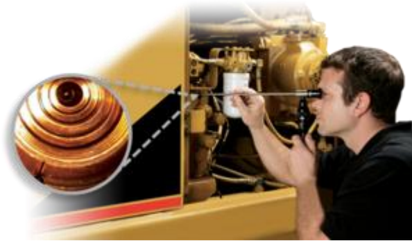
Slika 6. Vizualna kontrola uz pomoć Boreskopa [9]
