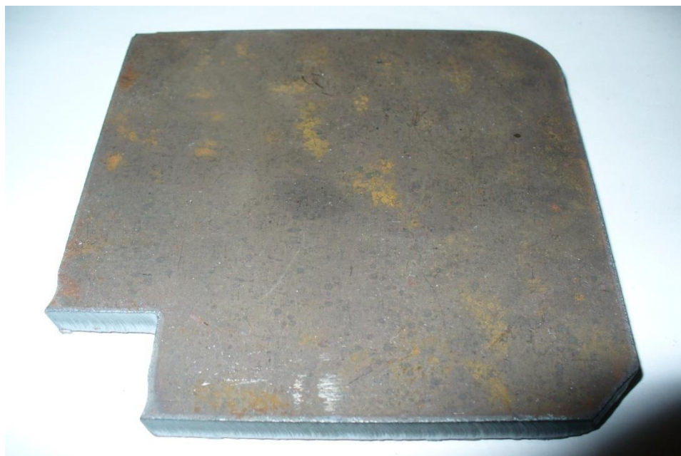
sl.39. Izradak br. 1. – REBRO (ugljični čelik S235JRG2)
