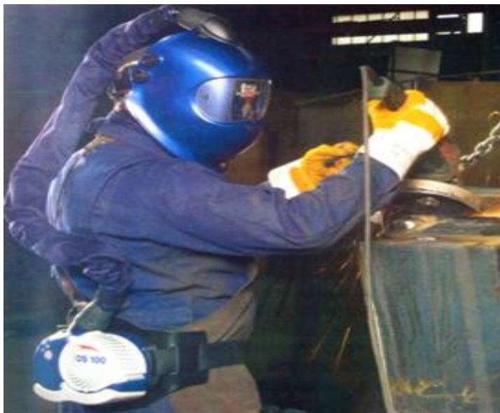
sl. 55 . suvremena automatska zaštitna maska s filterom
