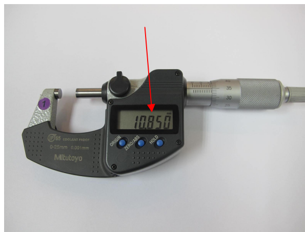
Slika 2.14. Digitalni obuhvatni mikrometar vrijednost 10,850mm
