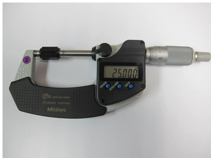
Slika 2.13. Digitalni obuhvatni mikrometar vrijednost 25,000mm
