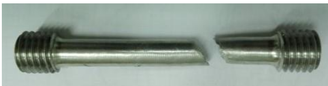
Slika 24. Lom epruvete TEGOTENAX V840 (druga strugotina)
