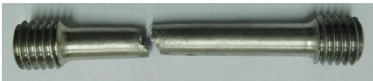
Slika 18. Lom epruvete TEGOTENAX V840 (nulta strugotina)
