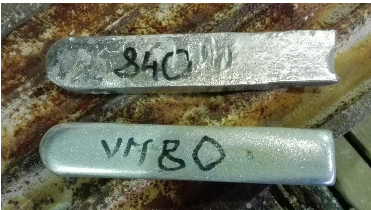
Slika 8. Odljevci bijele kovine (TEGOTENAX V840, WM 80)
