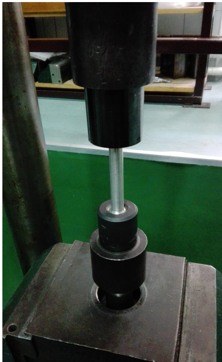
Slika 14. Postavljanje epruvete u kidalicu
