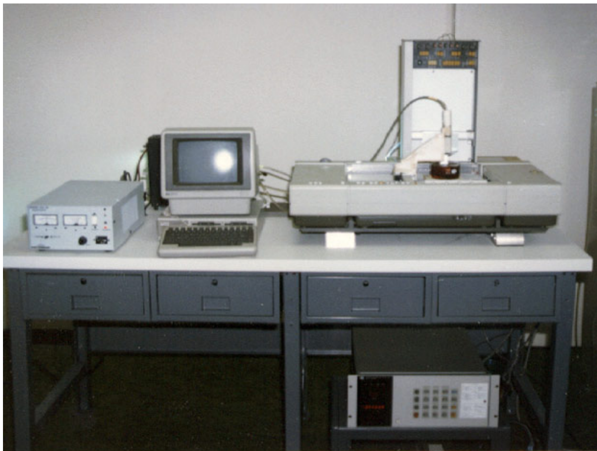
Slika 2.1. SLA-1, prvi 3D printer izumitelja Charlesa Hulla, 1983. godina
