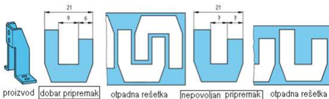
Slika 88. Prikaz dobrog i nepovoljnog priprema za povoljno iskorištenje trake materijala[5]
