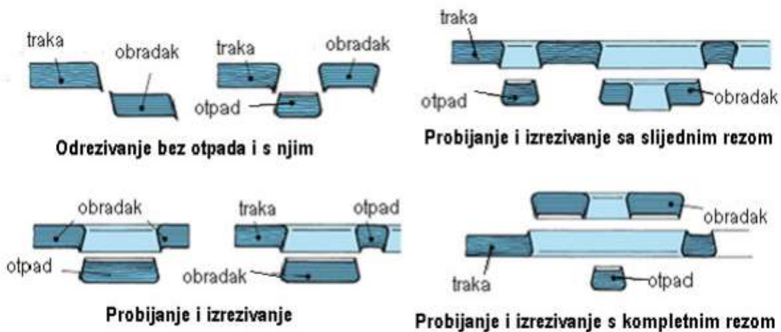
Slika 82. Položaj srha ovisno o postupku rezanja[5]
