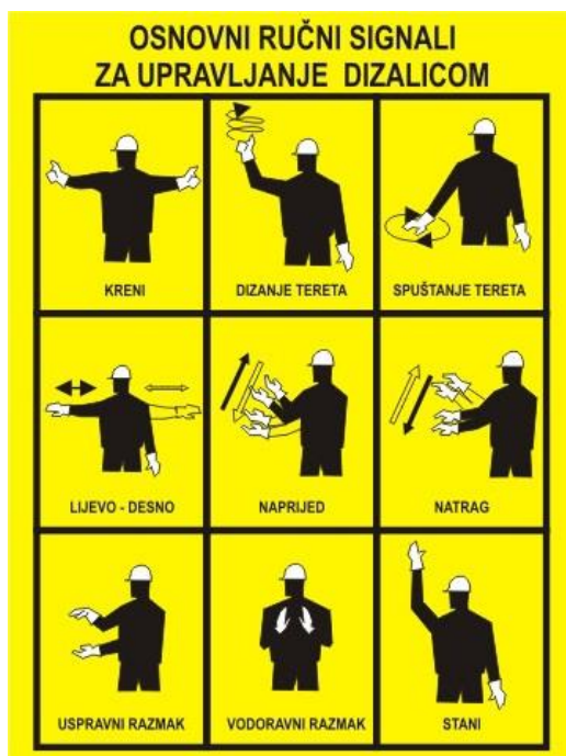
Slika 11 Signali pri radu s dizalicom
