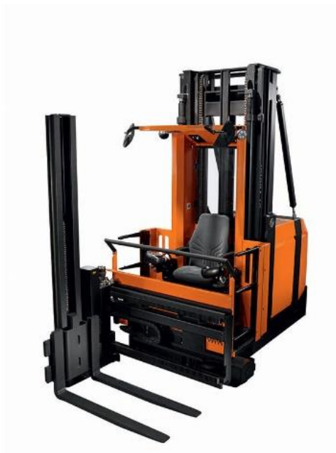
Slika 4. Električni visokoregalni viličar BT Vector A
