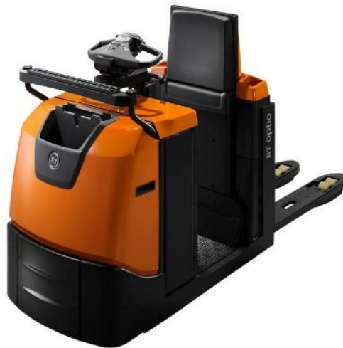
Slika 3. Električni komisioni viličar BT Optio L
