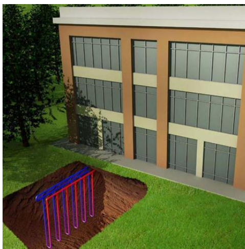
Slika 33. Vertikalni izmjenivači topline u geotermalnoj dizalici topline.
