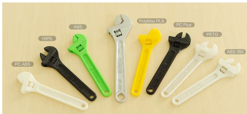
Slika 10. Primjer izrade 3D objekta različitim materijalima
