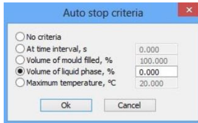
Slika 8. Postavke za regulaciju zaustavljanja simulacije „Auto stop criteria“ [5]
