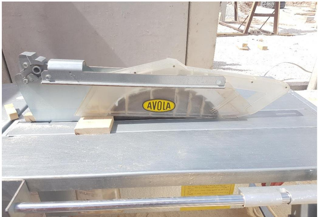
Sl. 2. Zaštitna naprava na kružnoj pili
