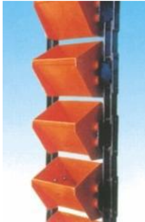
Sl.10. Posude elevatora
