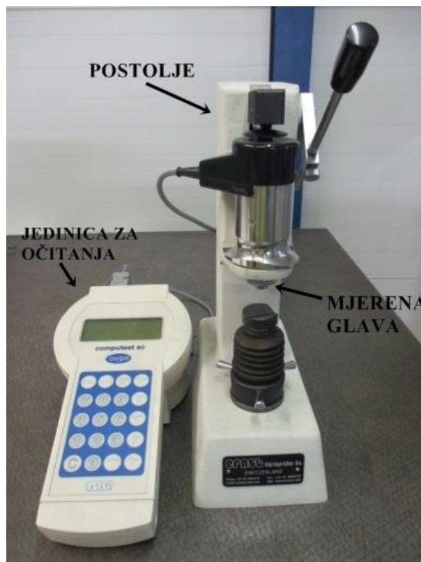
Slika 17. Dijelovi mjernog uređaja
