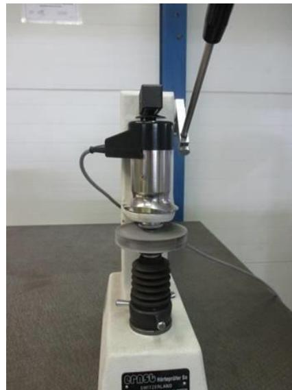
**Slika 19. Primjer postavljanja uzorka na postolje mjernog uređaja**
