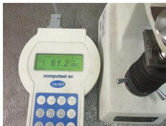
Slika 18. Interna provjera ispravnosti mjernog uređaja
