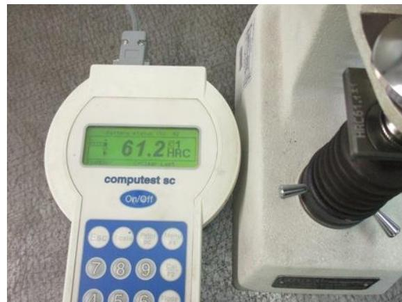
Slika 18. Interna provjera ispravnosti mjernog uređaja
