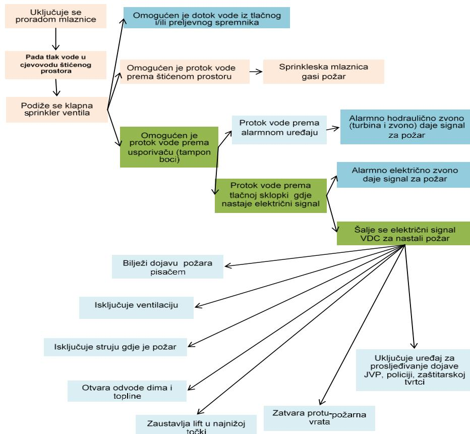
Slika 22. Shematski prikazan rada mokrog sprinkler sustava s automatskim radom
