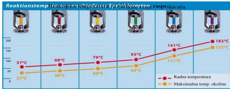
Slika 10. Sprinkler mlaznice sa staklenom ampulom [15]
