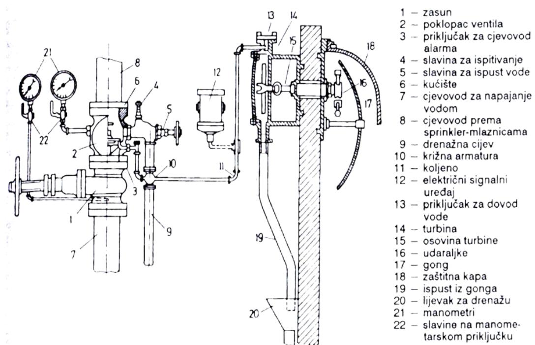
Slika 16. Mokri sprinkler ventil s osnovnim dijelovima [3]
