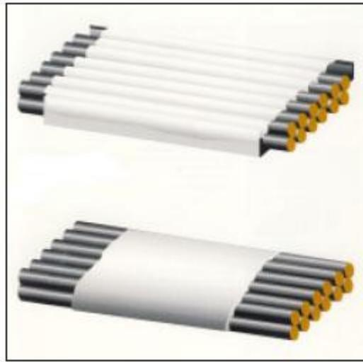
**Slika 18:** Protupožarna potpuna bandaža kabelskih polica [18].
