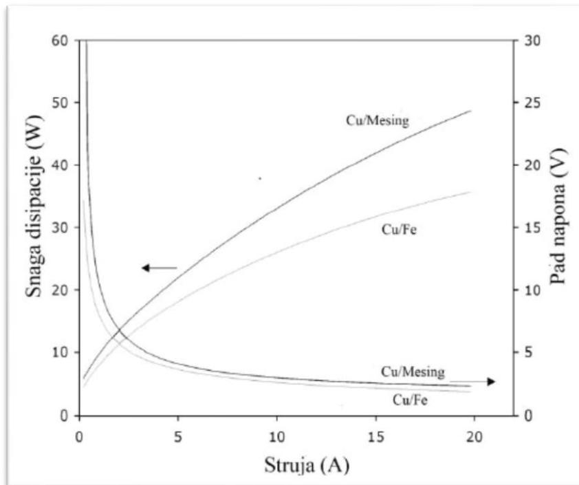
Slika 7: Snaga disipacije i pad napona na spoju dva vodiča od različitih materijala [15].
