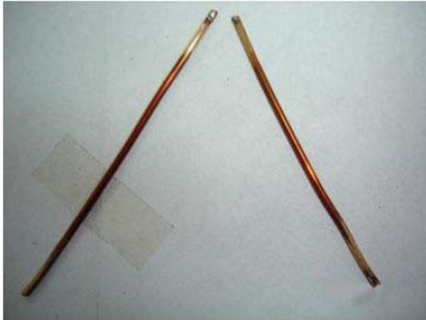
Slika 2: Prikaz tragova kratkog spoja na bakrenoj žici [12].
