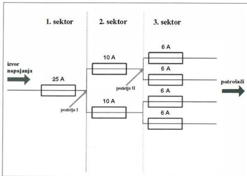
Slika 14: Jednopolna shema malog sustava električne instalacije [9].
