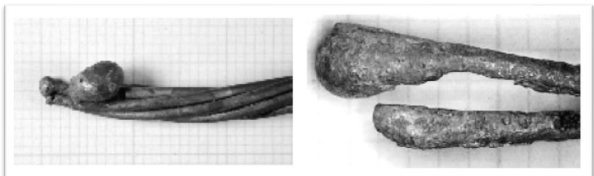
Slika 9: Prikaz kuglica nastalih kao posljedica požara [12].
