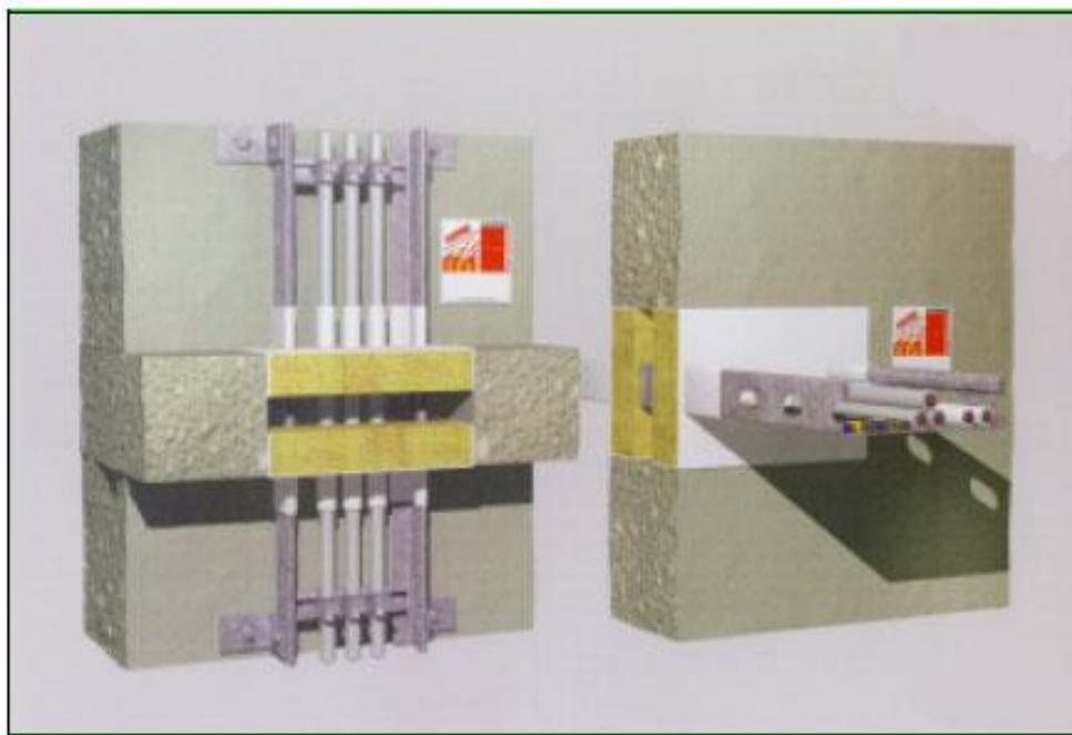
**Slika 21:** Protupožarna mekana pregrada [18].
