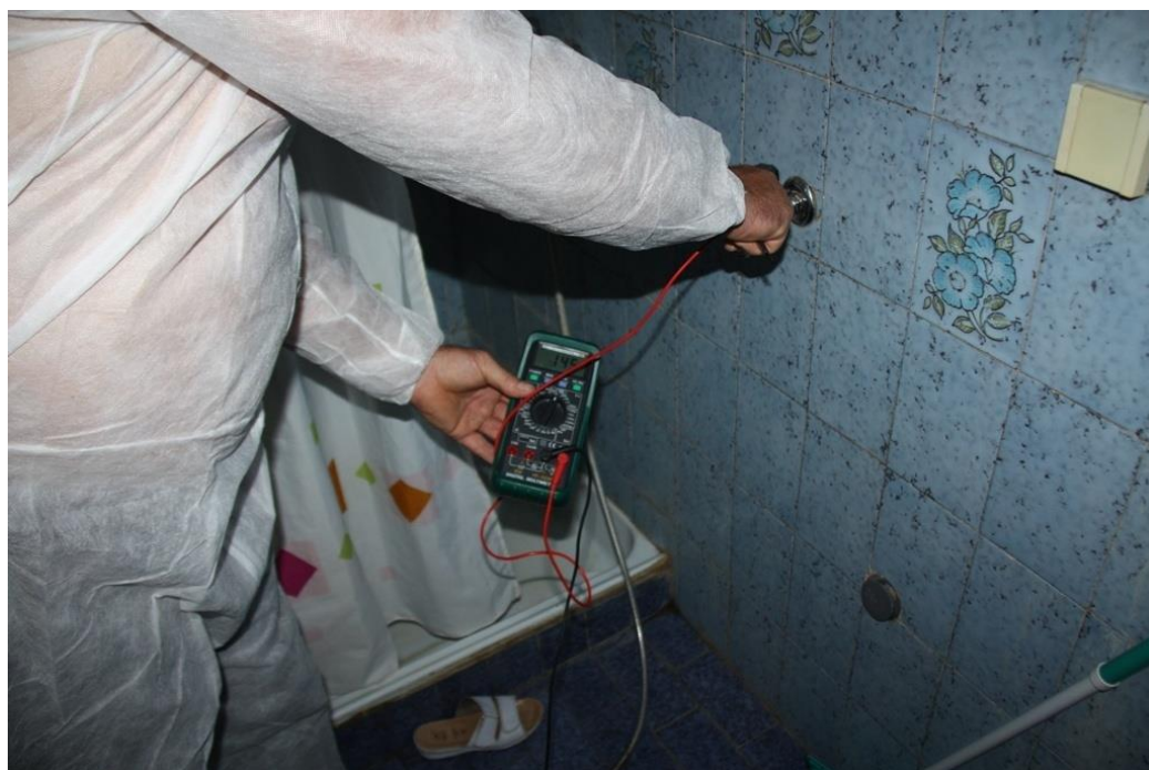
Slika 33: Ispitivanje električnih uređaja korištenjem digitalnog multimetra [20].
