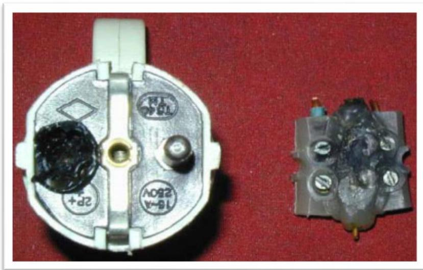
**Slika 12:** Taljenje materijala zbog zagrijavanja površine [12].
