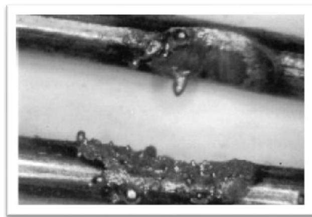
**Slika 8:** Prikaz kuglica nastalih uslijed električnog luka [12].
