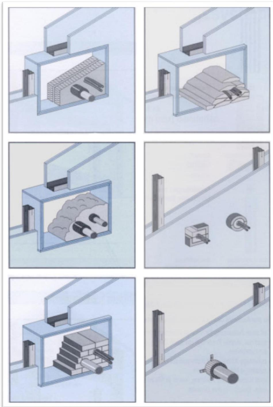
**Slika 29:** Pravilan način zatvaranja električnih instalacija suhomontažnom gradnjom [18].
