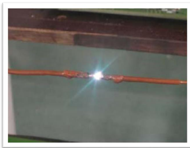
Slika 10: Serijski električni luk [12].
