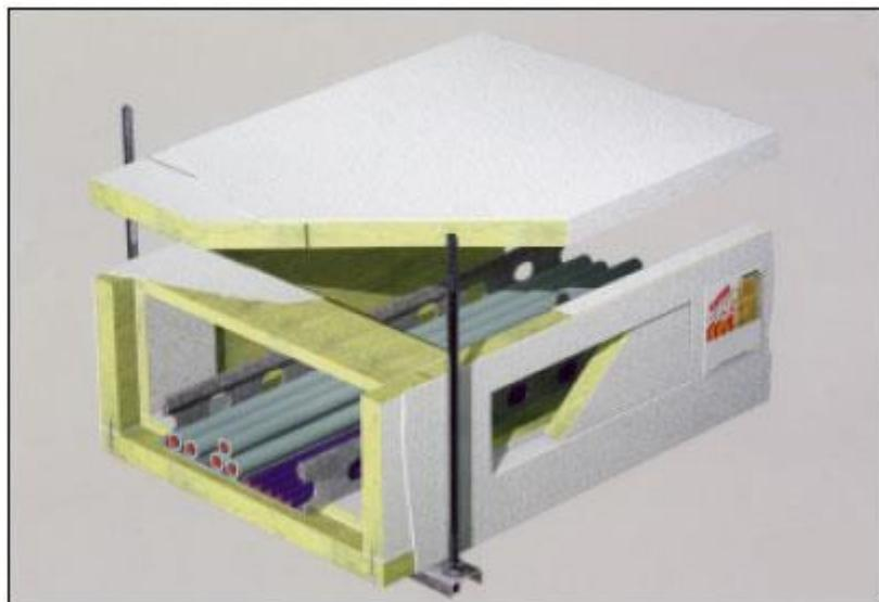
**Slika 17:** Protupožarni kanal [18].
