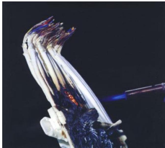
**Slika 16:** Demostriranje ponašanja protupožarnog premaza kabla pod utjecajem plamena [18].
