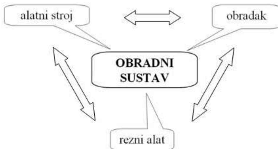
Slika 1. Osnovni elementi obradnog sustava [2]
