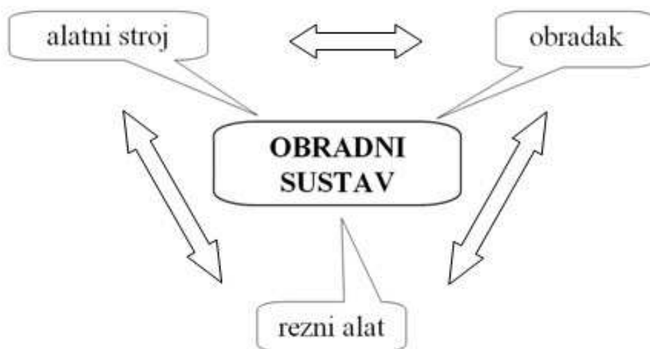
Slika 1. Osnovni elementi obradnog sustava [2]
