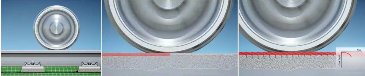
Slika 20. Pojava mikropukotina na željezničkim tračnicama [15]
