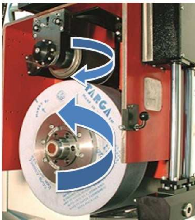
Slika 10. Sustav kontinuiranog profiliranja kod CDCF brušenja [12]
