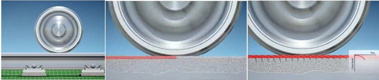
Slika 20. Pojava mikropukotina na željezničkim tračnicama [15]
