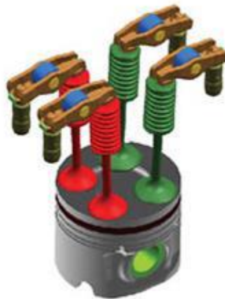
Slika 13 Viševentilska tehnika (4 ventila) [3]
