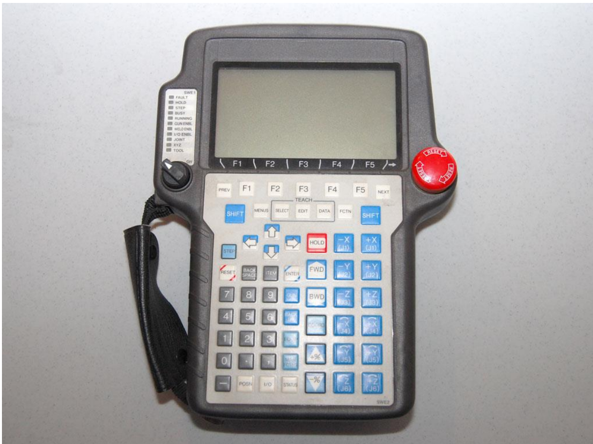
Slika 16. Teach pendant kod ON-LINE programiranja
