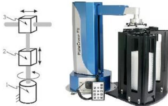
Slika 8. Kinematska shema i slika cilindričnog robota
