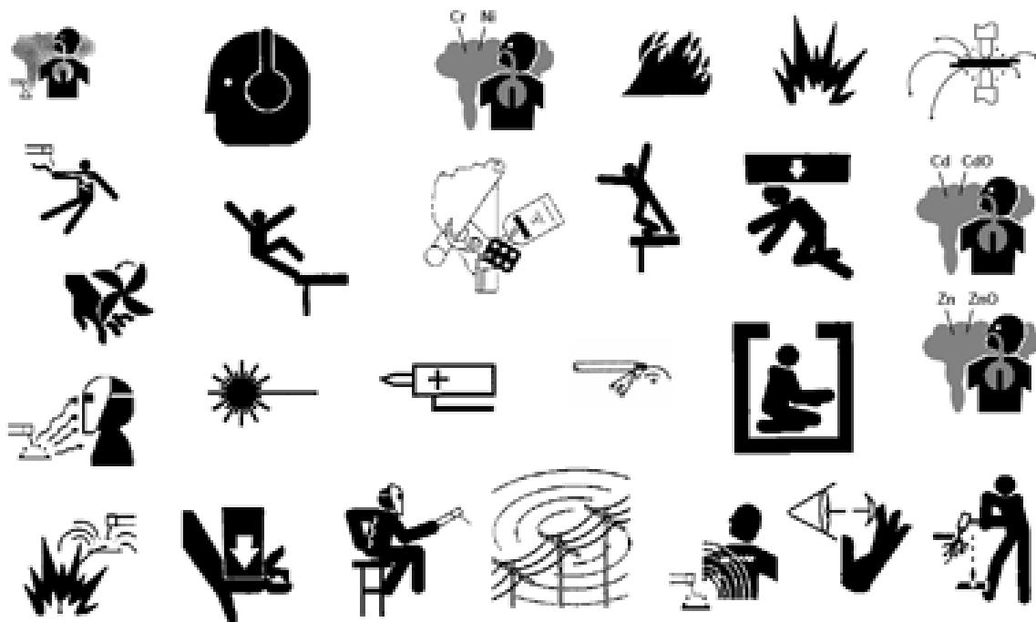
Slika 4. Mjere opreza kod ručnog zavarivanja
