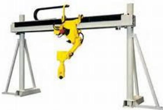
Slika 12. Primjer gantri robota
