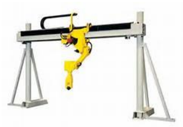
Slika 12. Primjer gantri robota
